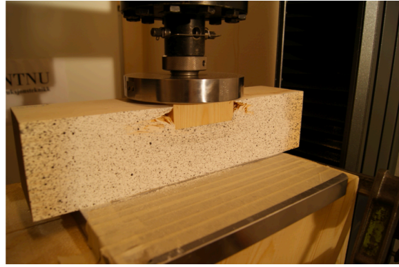
Figur 11: Lokal bruddmekanisme. Kilde: Troller (11)
