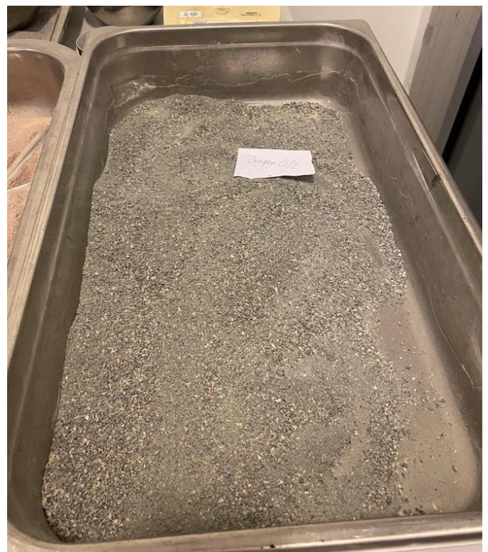
Figur 2-3: Ferdig preparert materiale til metylenblå- og sandekvivalentmetoden.
