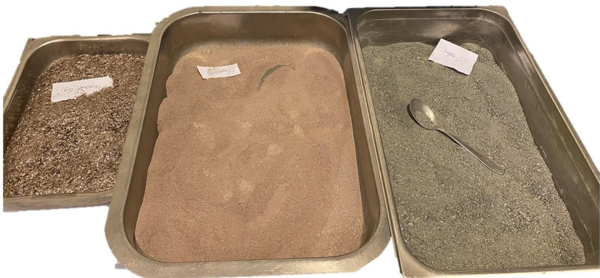
Figur 2-13: Preparert materiale til glimmerblandinger. Til venstre er opprinnelig flogopitt, i midten knust flogopitt og til høyre materiale nr. 2.
