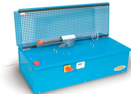
Figur 2-1: Til venstre; sandekvivalentutstyr, sylindere m.m. Til høyre; ristemaskin benyttet i sandekvivalent-testen. Hentet fra nettsiden til Nycander AB (2022).
