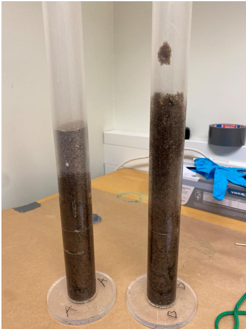
Figur 2-14: Sylindere til venstre er testen gjennomført slik beskrevet i standard. I sylindere til høyre er prøven i tillegg ristet for å fukte alt materialet, dette er ikke i henhold til standard.
