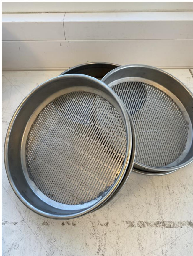
Figur 2-15: Speziallagde stavsikt for tester av flisighetsindeks for materiale mellom 0,8 og 4 mm.
