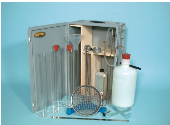
Figur 2-1: Til venstre; sandekvivalentutstyr, sylindere m.m. Til høyre; ristemaskin benyttet i sandekvivalent-testen. Hentet fra nettsiden til Nycander AB (2022).
