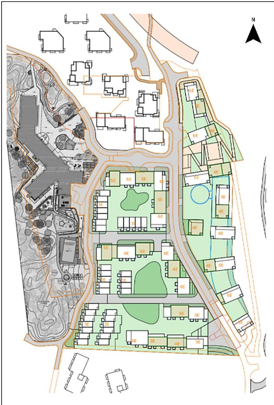
Figur 24: Skisse av alternativ 1. All eksisterende bebyggelse fjernes og erstattes med ny bebyggelse, se hvite og lysegrønne bygninger i figuren. Etasjehøyde er påført over bygningene i skissen. Eksisterende parkeringsanlegg under arealet til høyre i figuren bevares. Videre skal det tilføres parkeringskjeller under sentralområdet i midten av figuren. Adkomst til området er i nedre høyre hjørne. Laget av: Henning Larsen Arkitekter
