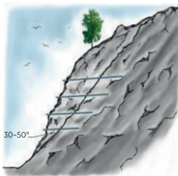
Figur 4.7: Anbefalt vinkel mellom bolt og sprekkeplan (NFF, 2020).
