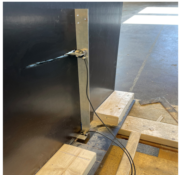
(b) Utstikkere fra rammen hviler på lastcellene, her på høyre side av renna.
