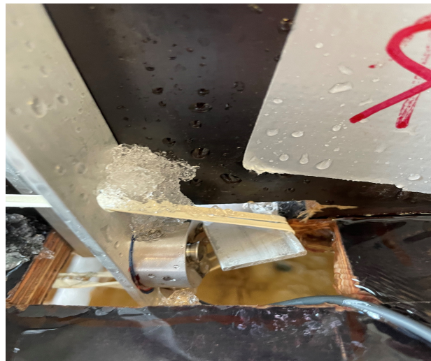
(b) Utstikkeren har ikke i kontakt med lastcellen.
