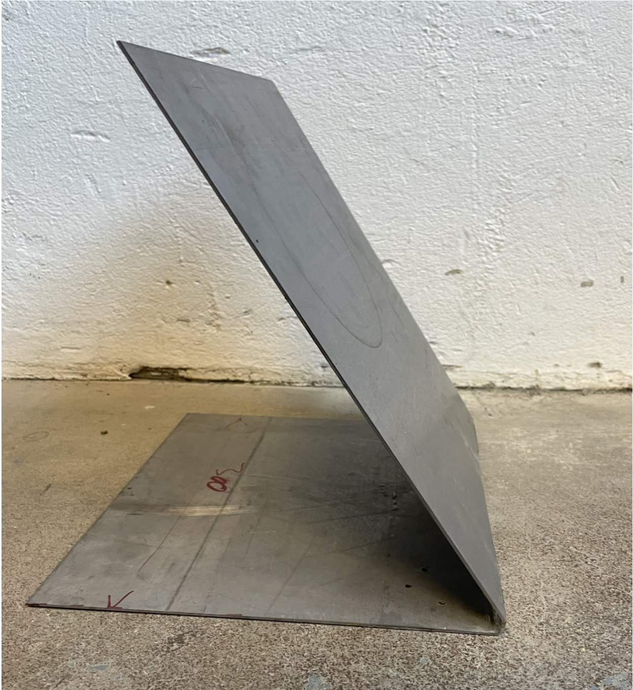
Figur 4.32: Trimmet plate etter forsøk 11. Platen har her gått til flyt.
