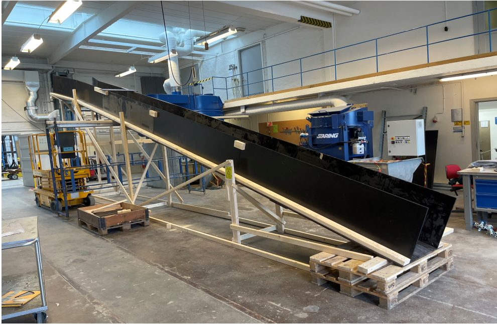
Figur 4.2: Renna med trakt, før kamera og platen ble montert.
