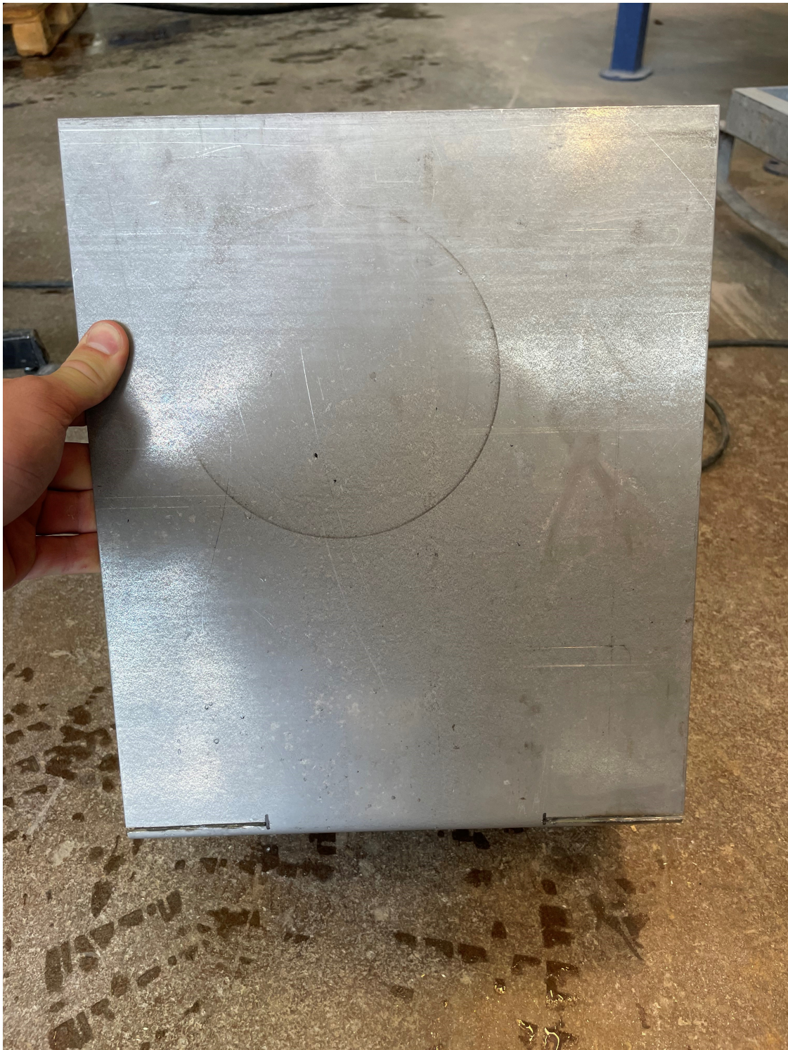
Figur 4.6: Den 2 mm tykke platen ble trimmet 7,5 mm på hver side før forsøk 11.
