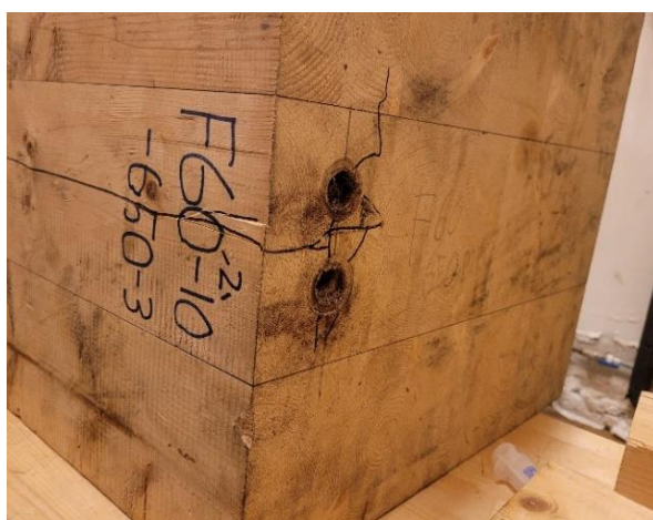
Figur 5-21: Eksempel på bruddform for konfigurasjon D. Splittelsesbrudd til venstre og skjærbrudd til høyre
