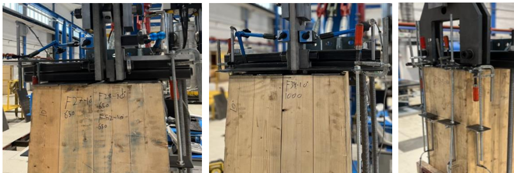
Figur 3-8: Plassering av måleinstrumenter. Konfigurasjon E til venstre, konfigur. D i midten og konfigur. V til høyre
