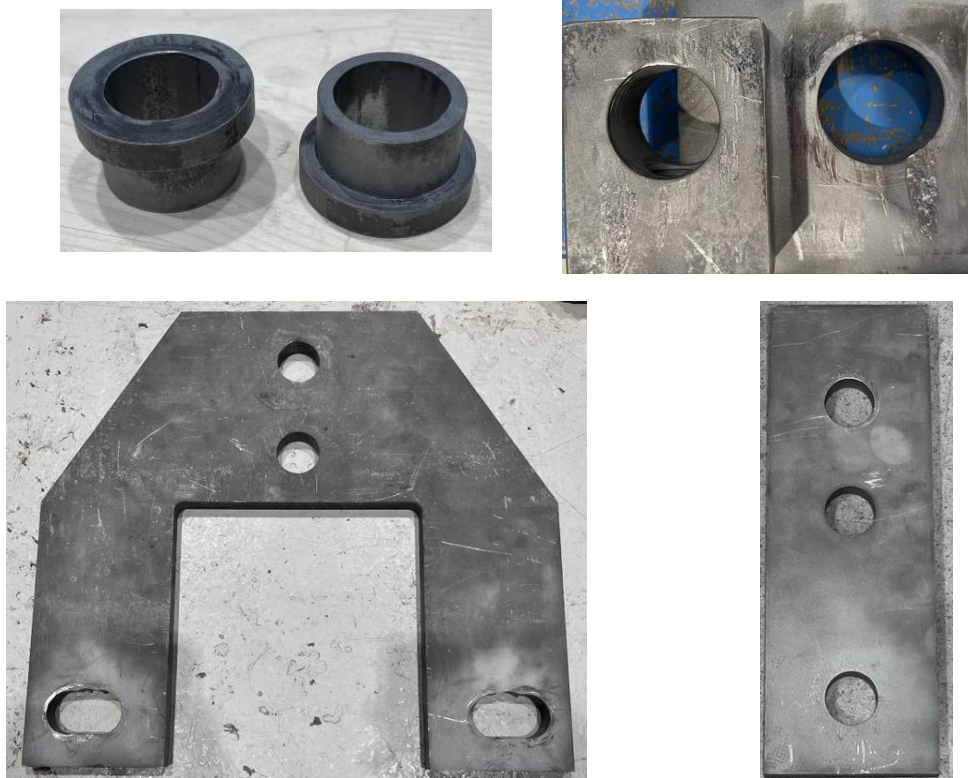
Figur 3-7: Stålkomponenter benyttet i forsøkene for å koble gjengestang til jekken
