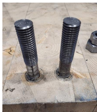
Figur 5-21: Eksempel på bruddform for konfigurasjon D. Splittelsesbrudd til venstre og skjærbrudd til høyre
