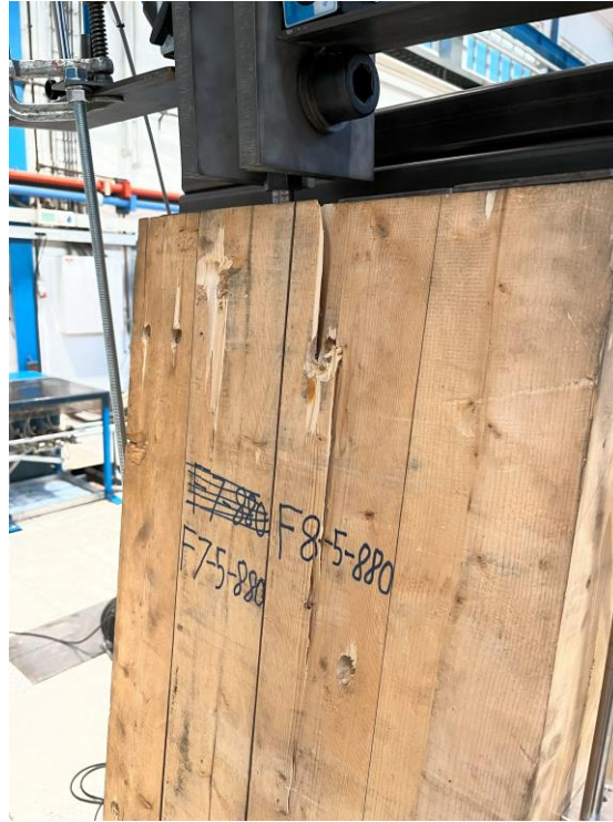
Figur 5-23: Brudd på grunn av rotasjon i prøvestykket (F7-E2-5-880)
