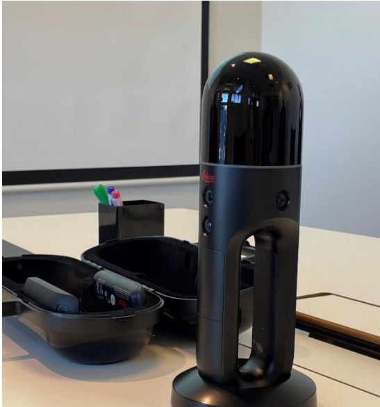
Figur 11 Håndholdt 3D-skanner fra produsenten Leica.
