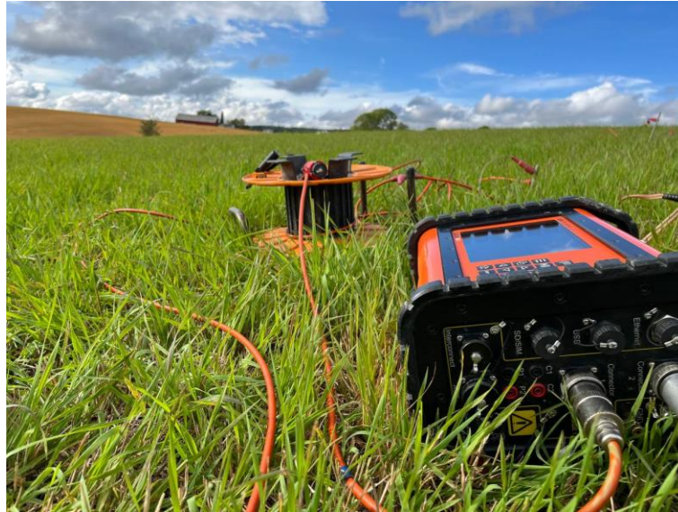
Figure 20. ABEM LS 2 Terrameter used in Gjerdrum
