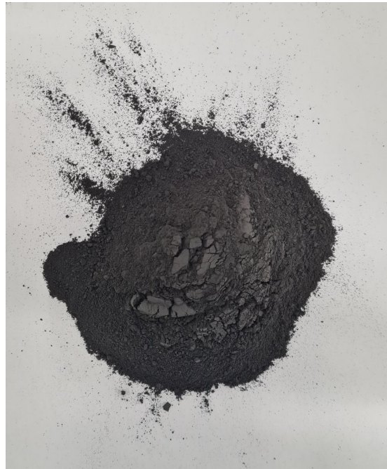
Figur C.22: Prøvematerialet av kjernebit fra 11 m klart til test for svelling av pulver. Prøvematerialet har vært gjennom “Fly Press Rock Crusher”, “Splitter” og “Skivesvingmølle”.
