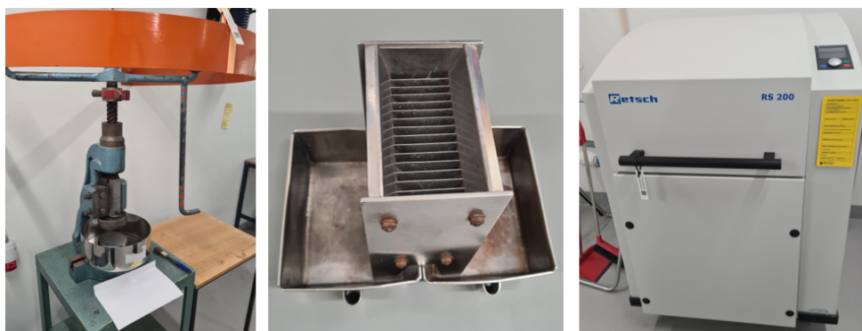
Figur 6.4: Fra venstre Fly Press Rock Crusher, Splitter og Skivesvingemølle som ble brukt for å knuse ned materialet og fordele det til et representativt utvalg.
