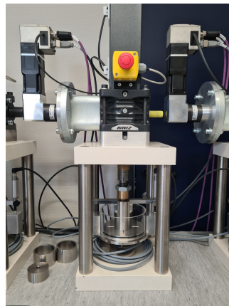
Figur 6.7: Apparaturl til test av svelling av pulver og intakt berg.
