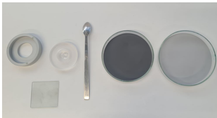
Figur 6.5: Prøve fra 11 m til venstre og 18,5 m til høyre tørket i en glassbeholder. Glassplate for å blande og jevne ut prøvematerialet og skje for å fordele prøvemateriale over i prøvebeholder som vises til venstre for skje.
