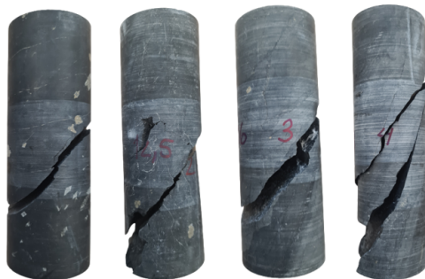
Figur 6.1: Prøvestykker etter test for enaksiell trykkfasthet. Kjernerprøve 1 til 4 fra venstre til høyre.
