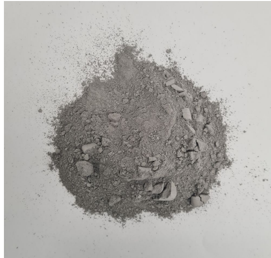
Figur C.23: Prøvematerialet av kjernebit fra 18,5 m klart til test for svelling av pulver. Prøvematerialet har vært gjennom “Fly Press Rock Crusher”, “Splitter” og “Skivesvingmølle”.
