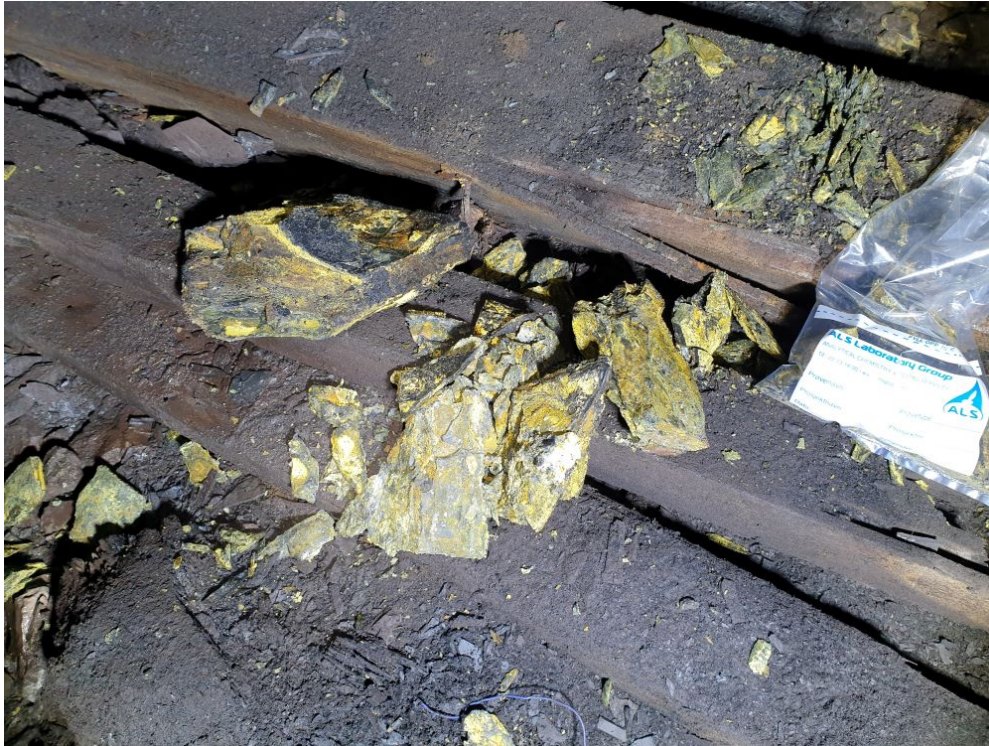
Figur B.10: Oppknust materiale av bergmassen i Heibergløkka tverrslag med gult forvitningsbelegg (Foto: Eivind Sømme Berget).
