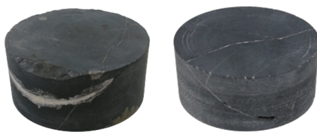
Figur 6.8: Prøvestykke fra 11 m til venstre og fra 18,5 m til høyre preparert til svelletest for intakt berg.
