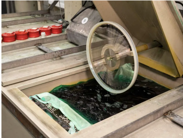
Figur 5: Nitrocelluloseplate etter første elektrolyse. (Sterba, 2017)
