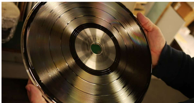
Figur 3: Form, også kalt Stamper, brukt til trykking av vinyl. (Sterba, 2017)
