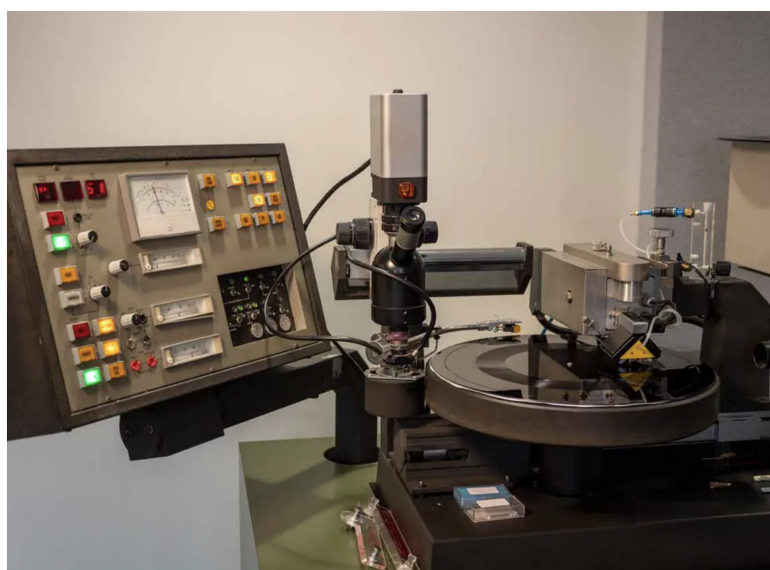
Figur 4: Neumann VMS 80 dreibenk brukt til å kutte i nitrocelluloseplater. (Sterba, 2017)
