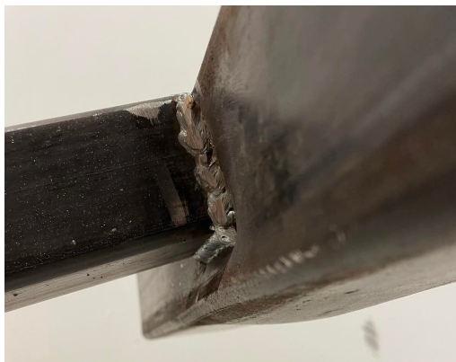
Figur 4.11: Deformasjon av knutepunktet i eksentrisk forsøk
