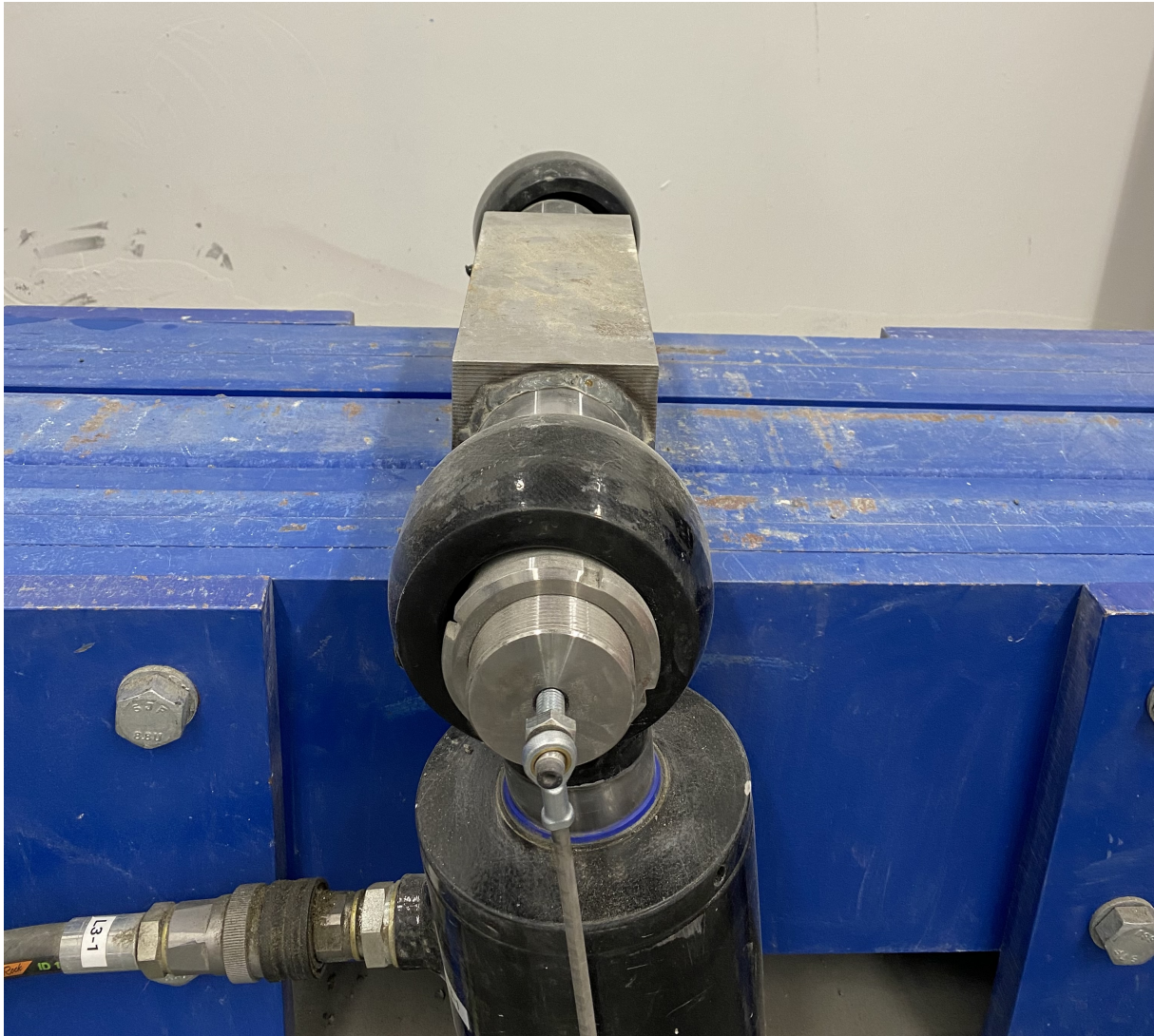
Figur 3.2: Ankerblokk av stål som styres av trykk fra de hydrauliske sylindrene og simulerer opptrekk av forankring. Ekstensometer er vist ytterst på sylindren.
