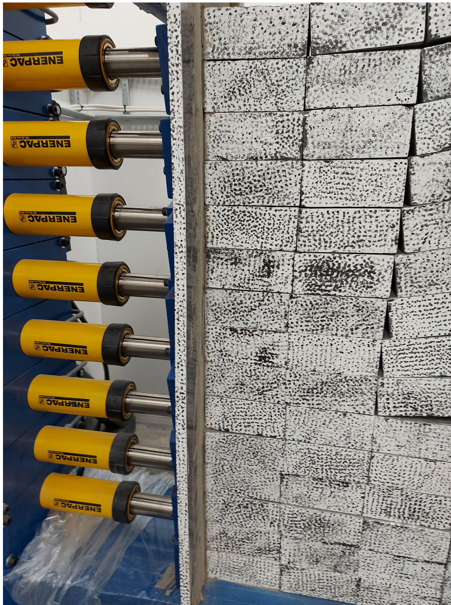
Figur 3.4: Treplate med støyp for en jevn overflate mellom veggen og stemplene.
