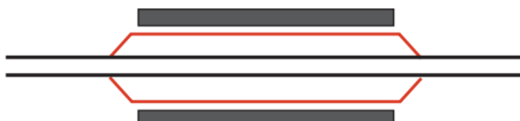
Figur 5 - Prinsippskisse som illustrerer stasjonsutforming lagt til grunn for flere store stasjoner i KVVU InterCity (Jernbaneverket, 2011b, s. 16), der utformingen tilsvarer byggeklossene for stasjoner med fire spor.
