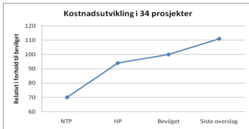
Figur 8 - Kostnadsutvikling gjennom ulike faser for ulike infrastrukturprosjekter, gitt justering med KPI. Figur fra (Bruland et al., 2012), og gjengitt i (Samferdselsdepartementet et al., 2016, s. 54).
