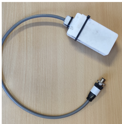
Figur 4.5: SCD30 med kabel, kontakt og hus
