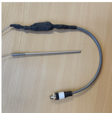
(a) Termoelement med MCP9600 i krympestrømpe, kabel og kontakt
