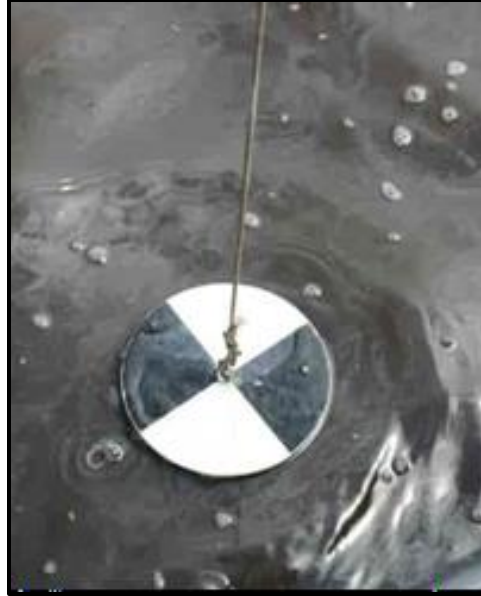
Figur 13: Secchiskive for å måle siktedyp (Hongve, 2020).
