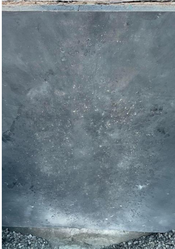
Figur 30: Skadeomfang på stålplaten på bakveggen etter tredje avfyring.
