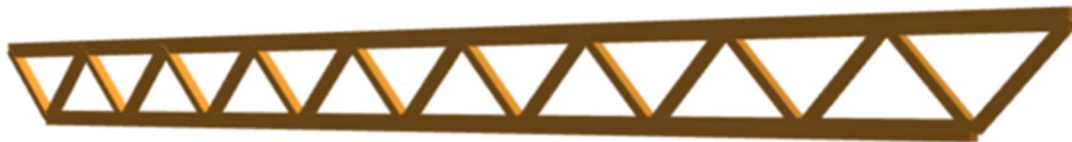
Figur 3: Eksempel på fagverk med parallelle gurter, modell 2. Kilde: Focus konstruksjon 3D
