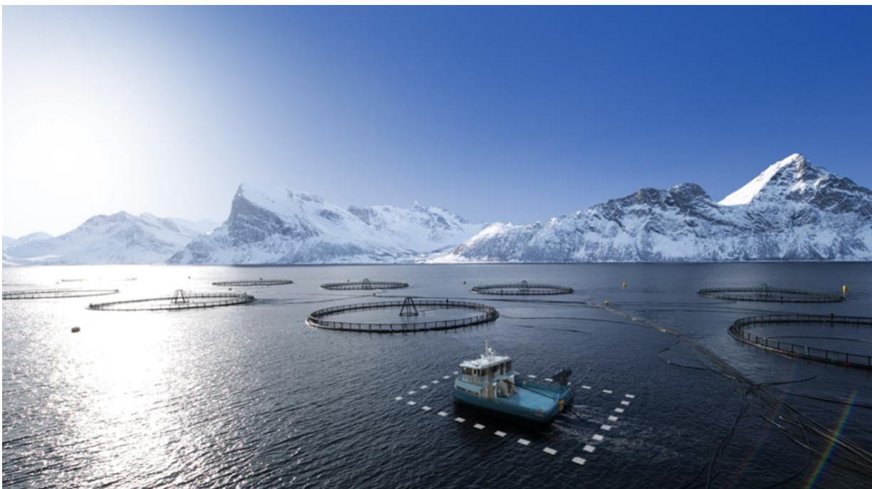
Figur 9 - Illustrasjon av en servicebåt som opererer med DP i et oppdrettsanlegg (HAVgroup, 2023)
