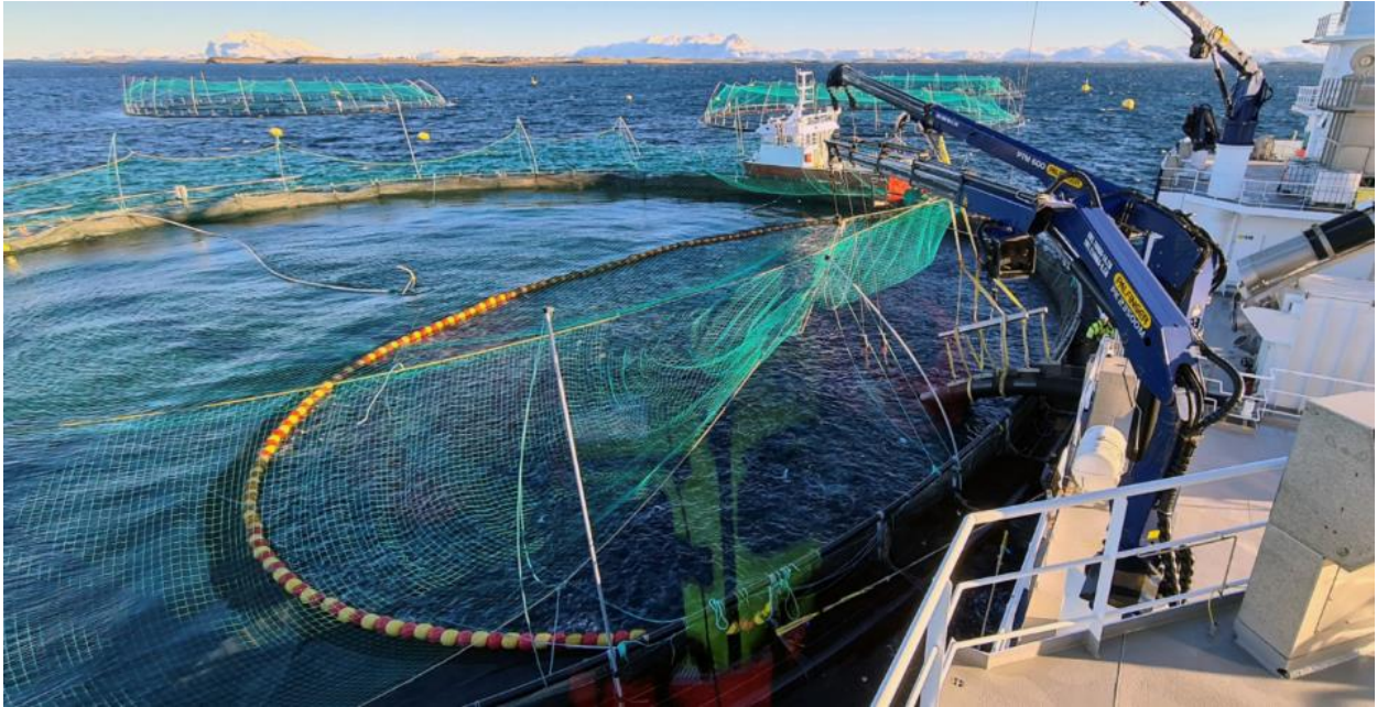
Figur 6 - Lasting av fisk ved hjelp av kulerekke (SinkabergHansen, 2021)
