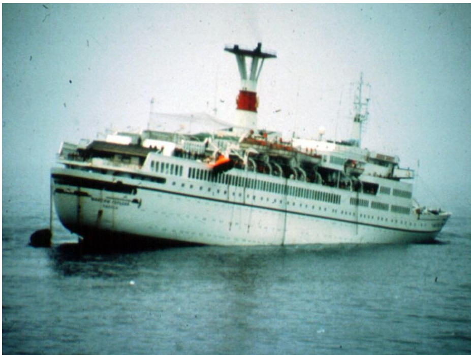
Figur 13 – Maxim Gorkij med vanninntrenging i baug etter kollisjonen (Kleiven, 2012).
