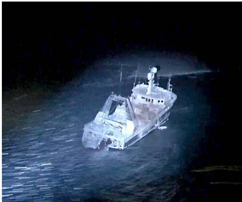
Figur 18 – Northguider med vanninntrenging og styrbord slagside (Rommetveit, 2019).
