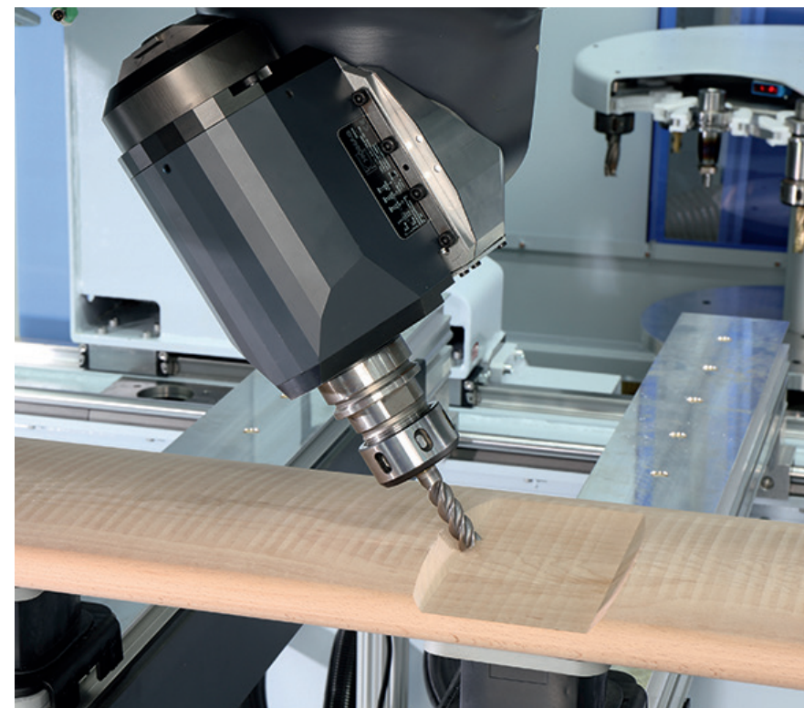
Komplekse former med høy presisjon. CNC-fres med 5 akser utvider det formlige mulighetsrommet når det kommer til produksjonsteknikker. (Woodworking Network, 2023)
