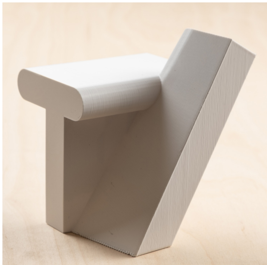
3d-printet detalj i 1:1 av møtet mellom ryggene, armlene og bakbein.
