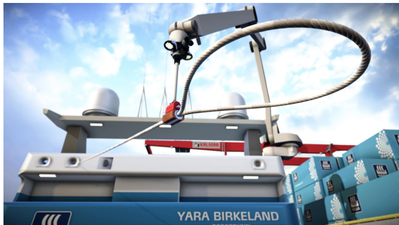
Figur 2.3: Automatisk gripearmløsning på lasteskipet Yara Birkeland (Bilde). Macgregor - https://www.macgregor.com/intelligent-solutions/automated-mooring-system/ (Hentet: 28.03.2023).
