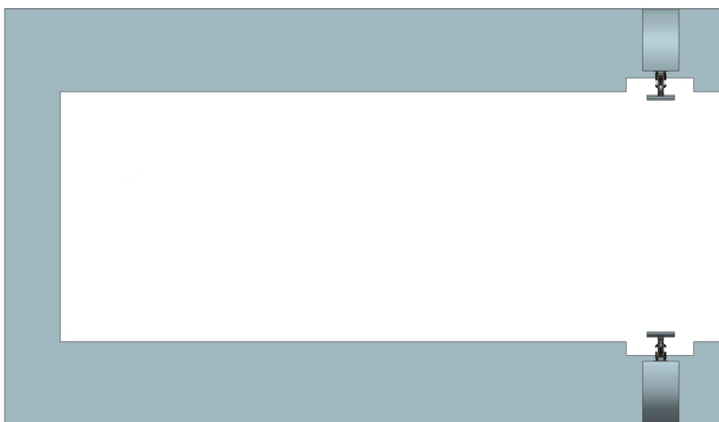
Figur 4.1: Figuren viser et situasjonsbilde av konsept 1. Her inngår det en forenklet modell av kaien sammen med to like lade- og fortøyningsløsninger. Figuren illustrerer et av de to forskjellige systemene i Geiranger og Linge.
