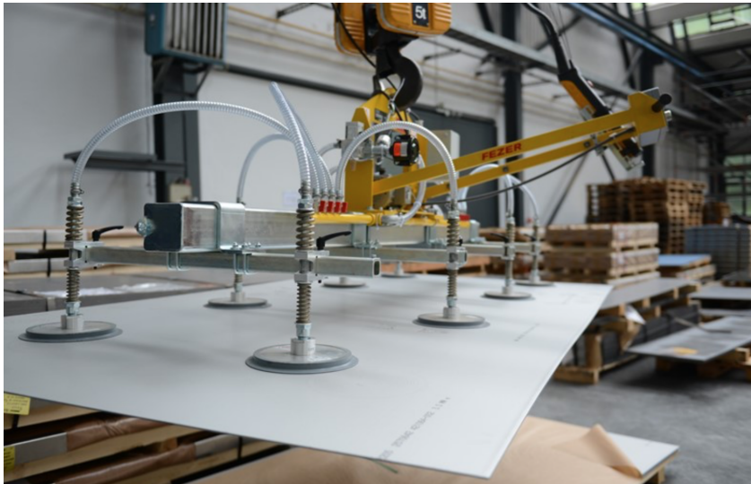
Figur 2.1: Vakuümenteknologi anvendes innenfor flere industrier (Bilde). Bretteville - https://www.brettevilletaljer.no/vakuümløfter/loft-av-plater/vacuboy-vakuümløfter/-for-plater-opp-til-2-tonn (Hentet: 28.04.2023).
