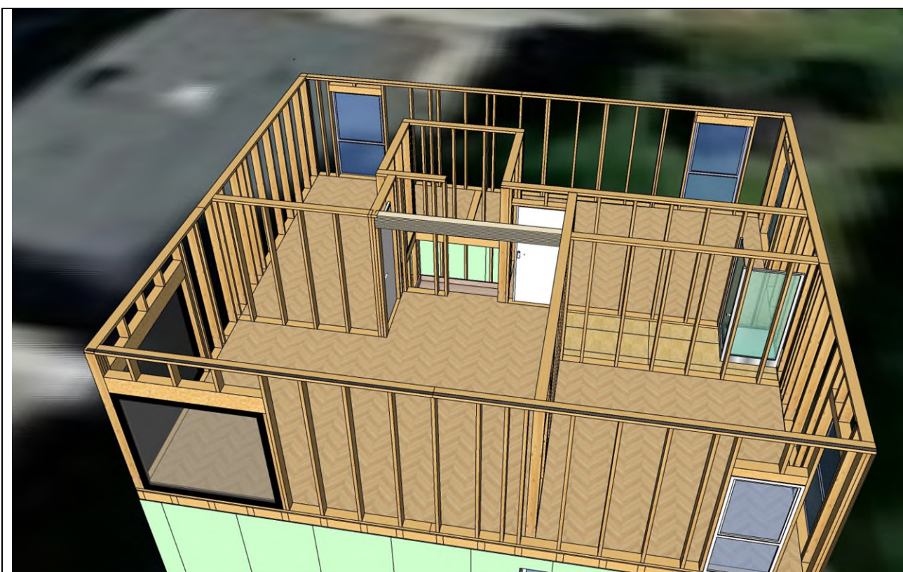
Bærende veggstendere sett ovenfra øst-siden. Innsatt limtre dager for å støtte opp taksperrer.
