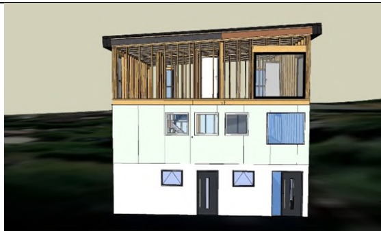
Husets fasade sett fra nord uten kledning og tak-detaljer
