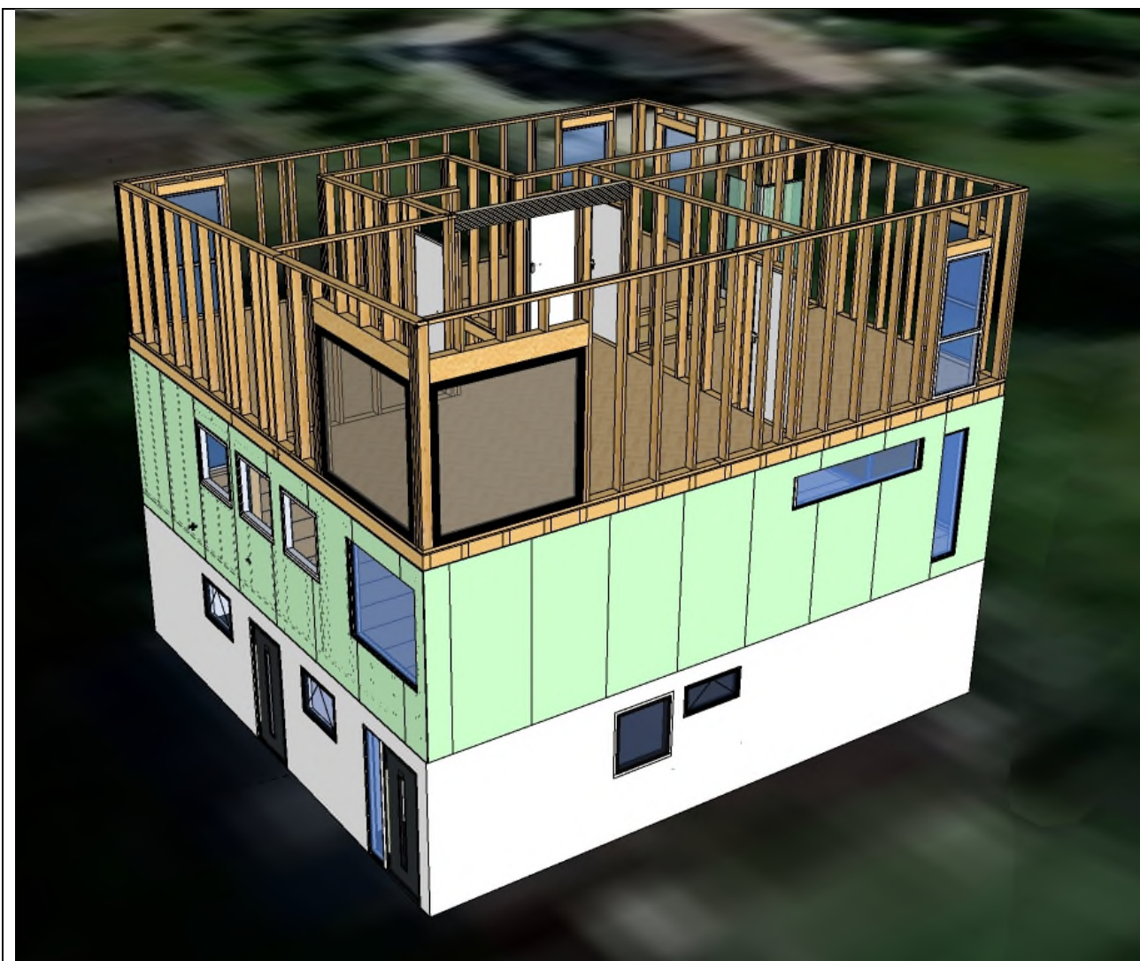
Bærende veggstendere sett ovenfra nord/sør hjørnet.
