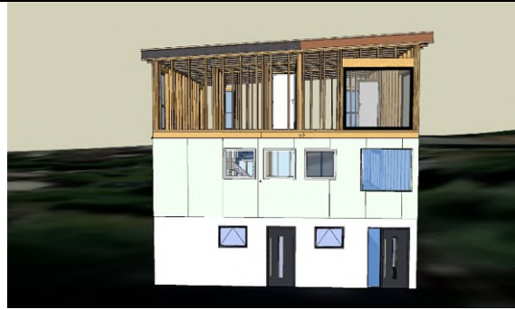
Husets fasade sett fra nord uten kledning
