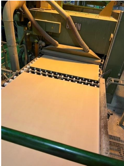
Figure 12 Platene får overflatebehandling, foto: Privat
