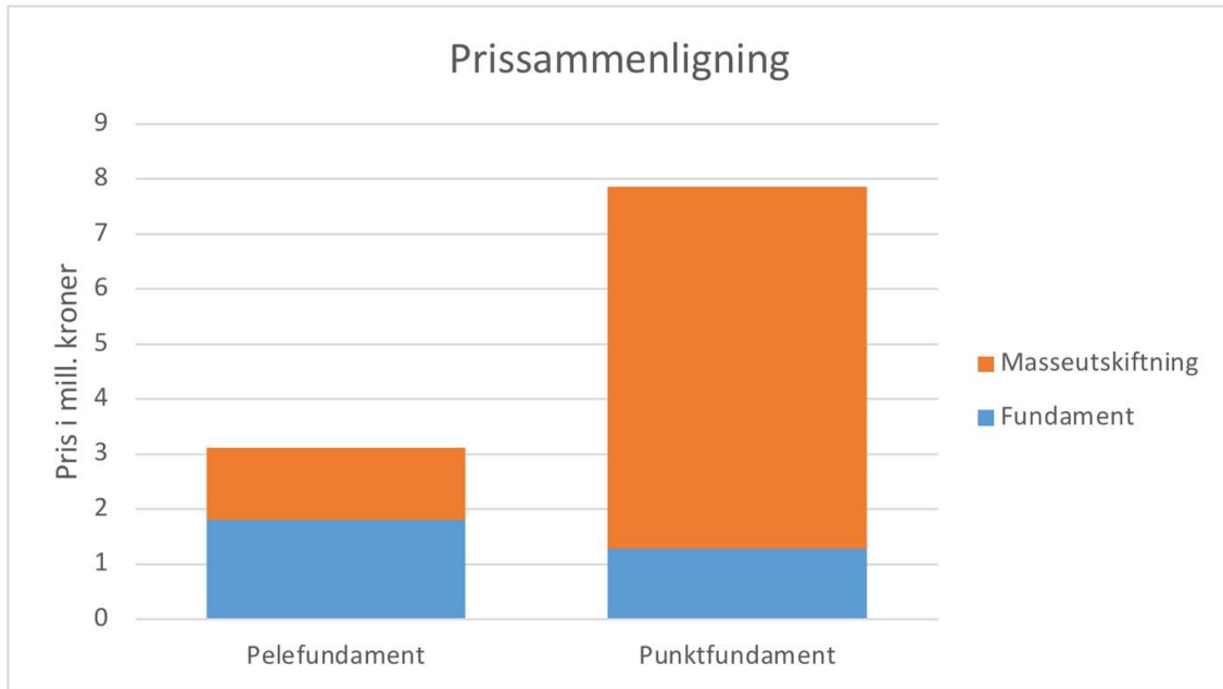
Figur 26: Prissammenligning for pele- og punktfundament (Personlig kommunikasjon)
