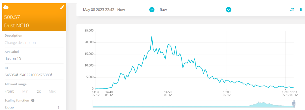
Figur 19 Resultat fra støvsensor NC10, det er en type sensor som brukes til å måle konsentrasjonen av partikler i luften, spesielt partikler med en diameter på 10 mikrometer eller mindre
