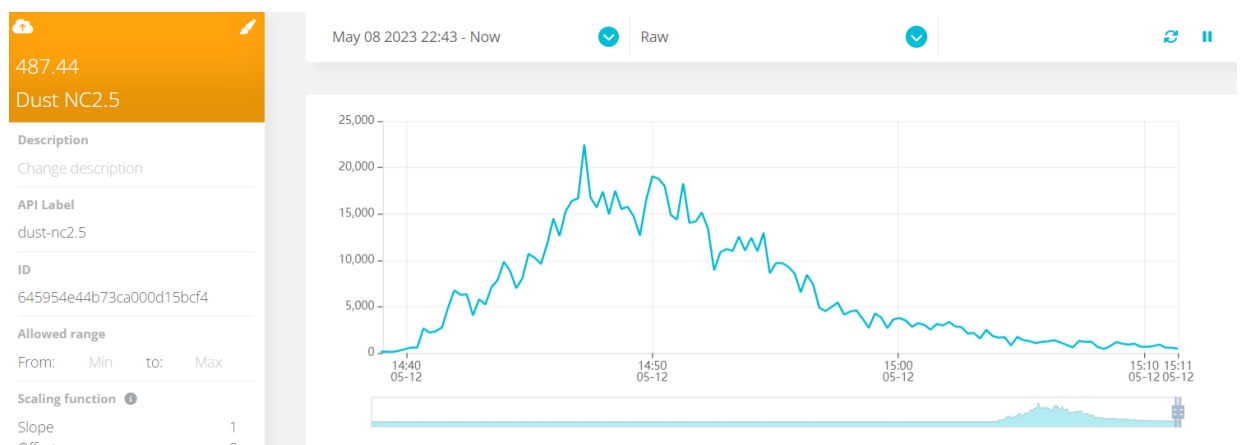
Figur 18 Resultat fra støvsensor NC2.5, det er en type sensor som brukes til å måle konsentrasjonen av partikler i luften, spesielt partikler med en diameter på 2,5 mikrometer eller mindre
