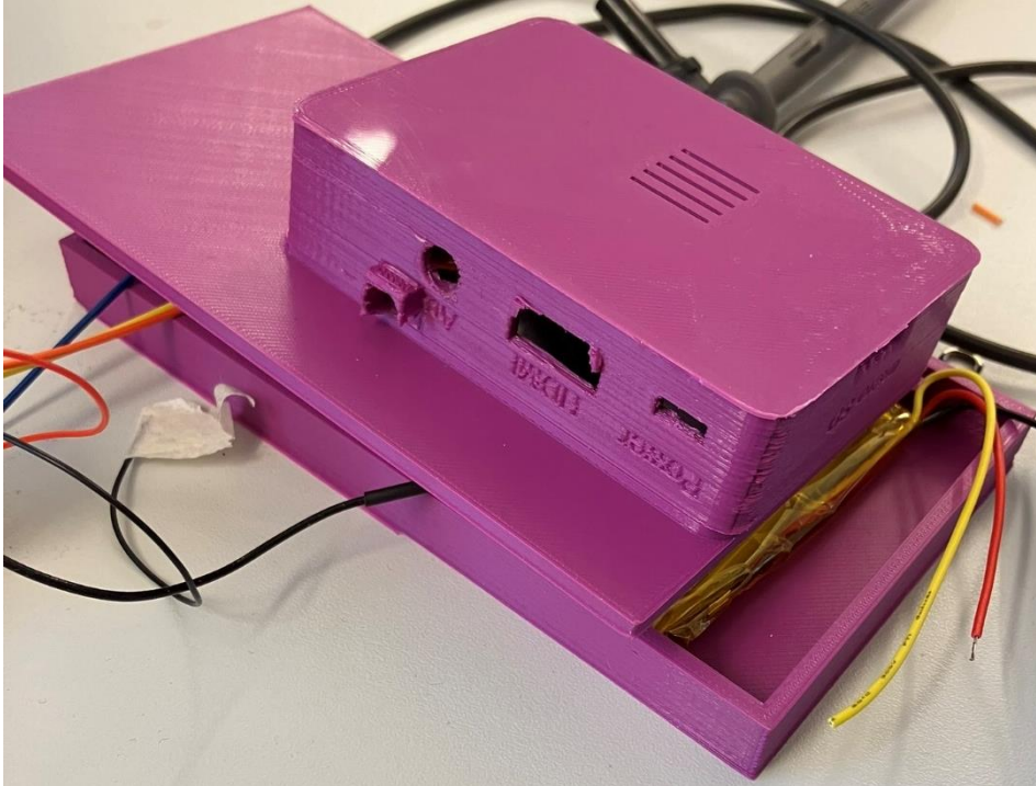
Figur 16 LoRa mottaker under montering, boksen var opprinnelig laget for å romme Raspberry Pi 3 Modell B+
