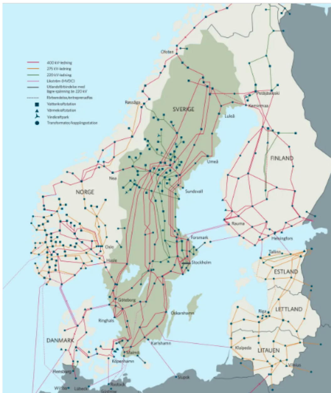
Figur 2.6: Oppbygging av strømmettet til Skandinavia [18]
