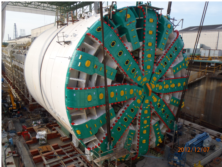
Figur 1: En TBM på 17.4m brukt i Washington [4]
