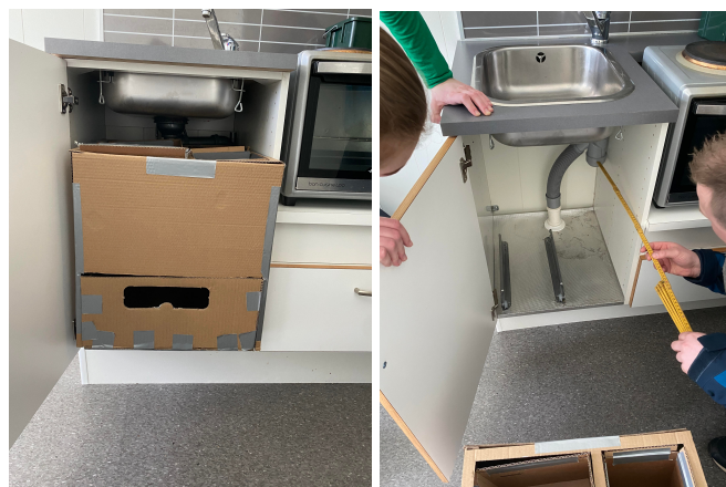
Figur 27: Prototypen var for dyp og passet derfor ikke inn i kjøkkenskapet i den tomme studentboligen, derfor ble det tatt nye mål av kjøkkenskapet.
