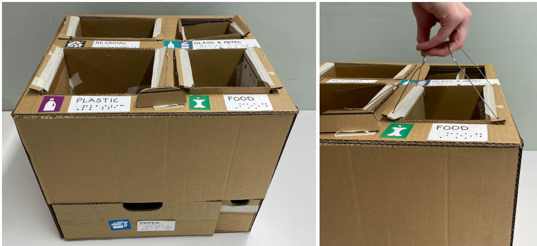
Figur 29: På den tredje prototypen i papp ble det laget en skuff til oppbevaring og festet merkelapper, håndtak på avfallsdunkene og en hendel på toppen.
