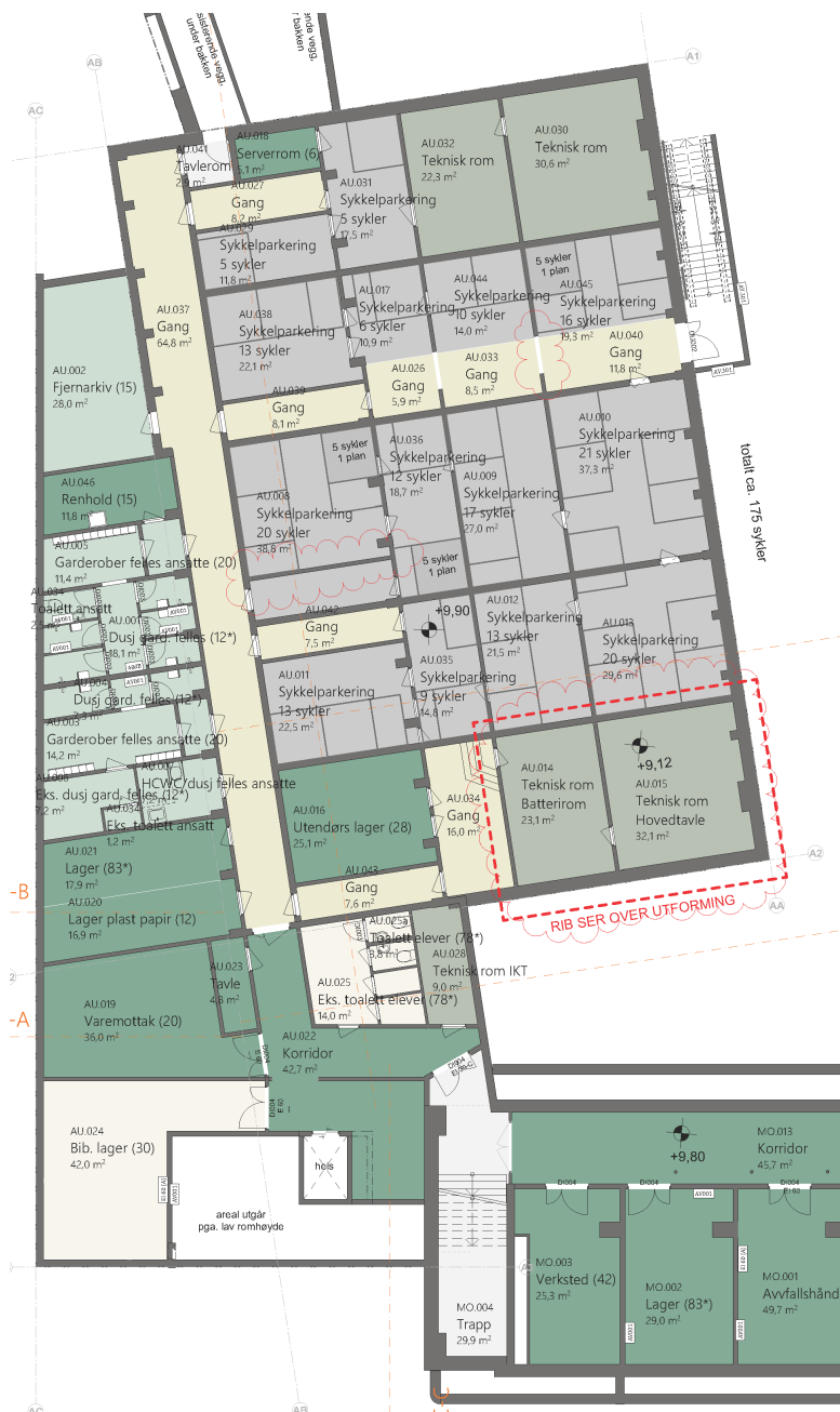
Figur 8.9: Utsnitt av kjelleren på Aula-bygget. Rødt avgrenset område viser batterirommet. Bildet er hentet fra Rambøll.
