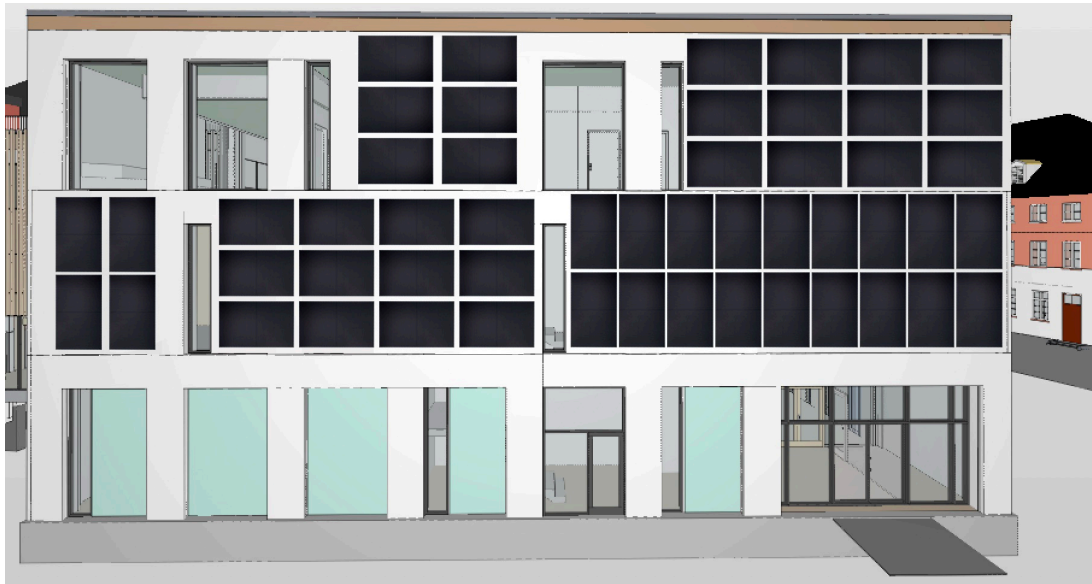
Figur 8.5: Solceller på den sørliggende fasaden med Series 6. Bildet er laget i Photoshop
