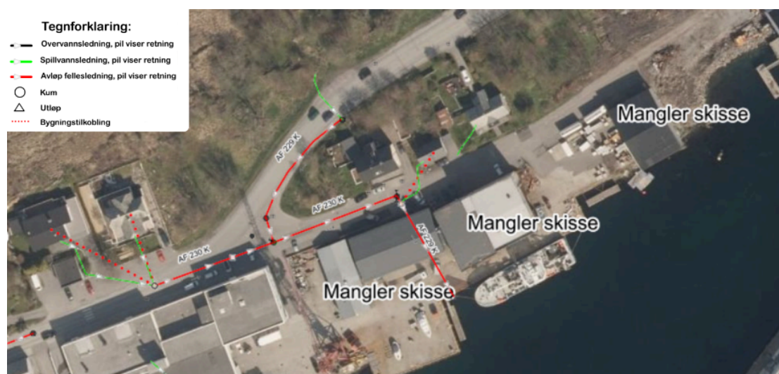
Figur 1.3.2: Bildet er fra Skarbøvika og er et eksempel på et område som mangler både skisser, ikke er tilkoblet ledningsnettets og som har direkteutslipp. Bildet er hentet fra Gemini Portal+ og var hentet i målestokk 1:1249.
