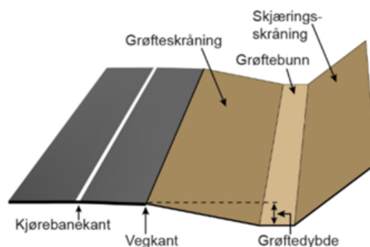
Figur 26: Grøfteelementer ved stigende terreng (SVV 2023x)
