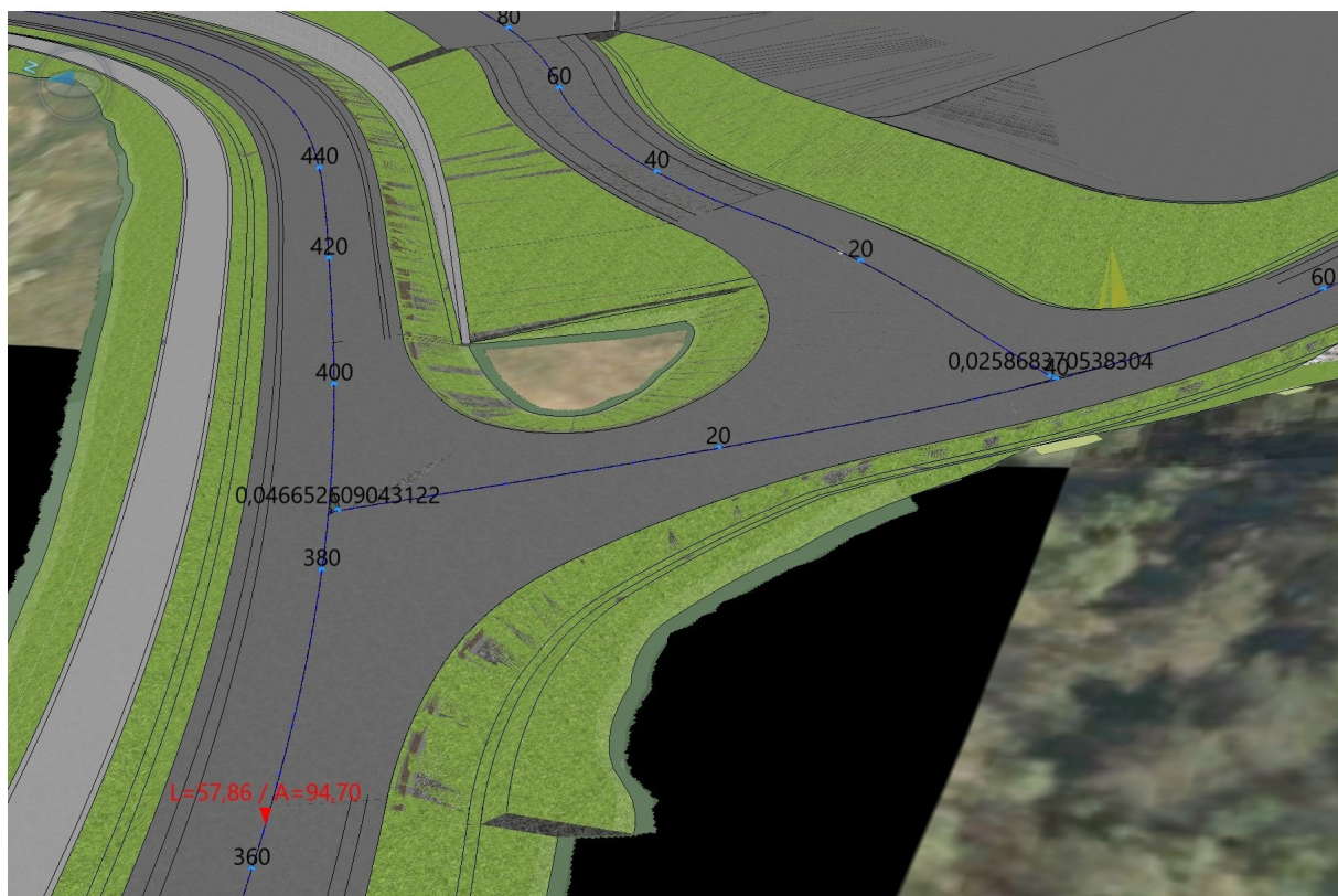
Figur 45: Prosjektert kryss mellom 20 000, 30 000 og 31 000
