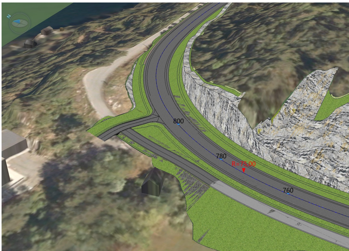
Figur 49: Prosjektert avkjørsel mellom 20 000 og 24 000
