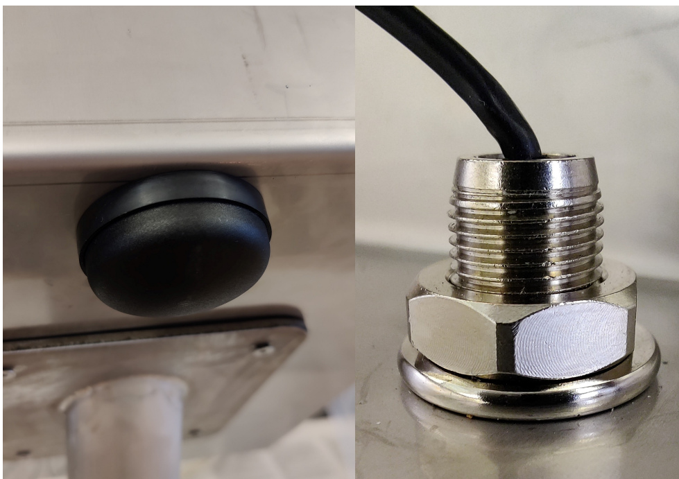
Figur 91: Antennen montert til kabinettet, vist på over- og undersiden.
