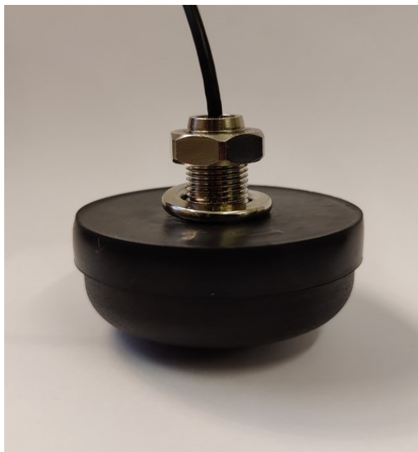
Figur 49: Undersiden av antennen har et gummibelegg som sørger for at vann ikke vil kunne trenge inn i terminalen.
