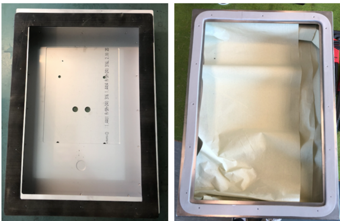
Figur 53: Terminalens kabinett montert med neoprenpakning til venstre. Til høyre vises terminalens kabinett montert med vinylskumgummi-pakning.
