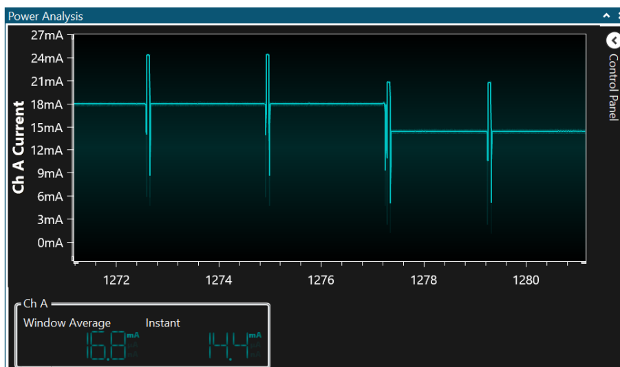
Figur 30: Strømforbruk ved vanlig operasjon. x-aksen beskriver tid i sekunder fra målingene startet, y-aksen er strømtrekket til modemmet gitt i milliampere.
