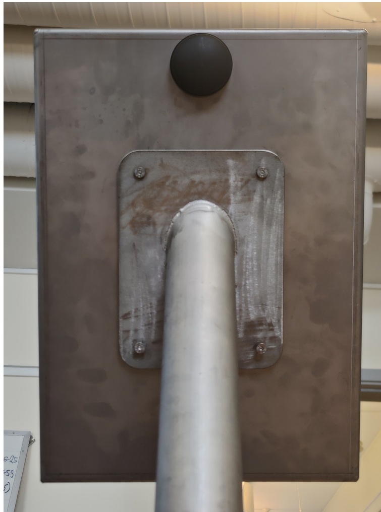
Figur 87: Festeanordning for kabinett til pedestall.
