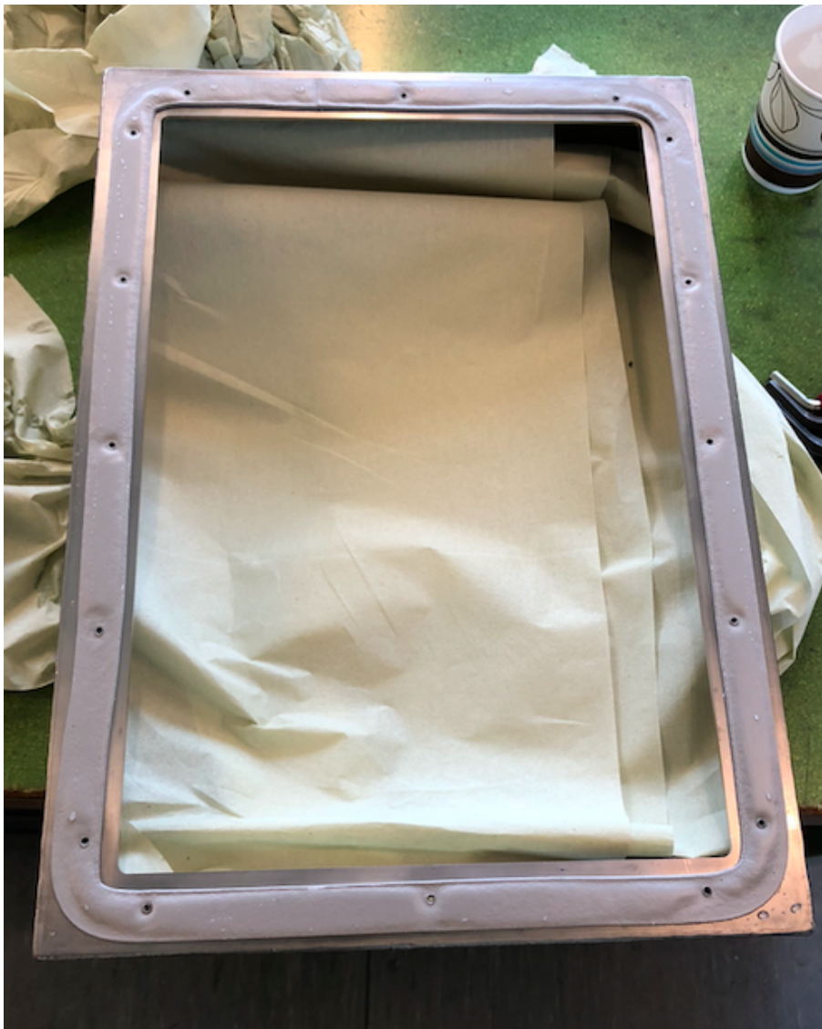
Figur 85: Tørr indre del av terminalens kabinett etter gjennomført vanntest med vinylskumgummi-lister. Papir ble plassert i terminalens kabinett for å gi tydelig indikasjon dersom vann trengte inn i kabinettet.
