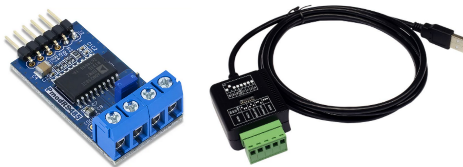
Figur 61: Til venstre vises PmodRS485 ( PmodRS485 2023) og til høyre EX-1309-T ( EX-1309-T 2023).
