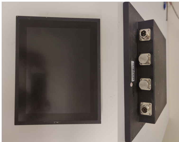
Figur 42: Vanntett og vandalsikker utendørsskjerm mottatt fra oppdragsgiver, med vanntette konnektorer.
