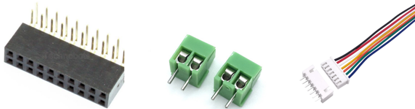
Figur 58: 2x10 Angled Female Pin Header til venstre ( Angled Female Pin Header 2023), skruterterminal i senter ( Skruterterminal 2023) og JST kontakt til høyre ( JST konnektor 2023).
