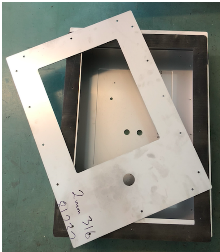
Figur 47: Terminal med pakning for vannsikring.
