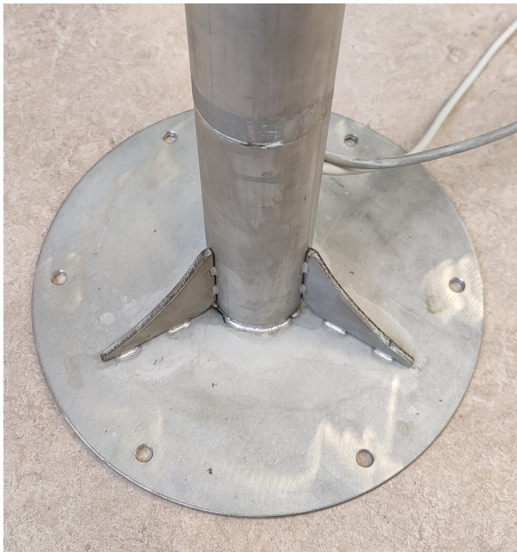
Figur 86: Festeordning for montering av terminal til bakken.
