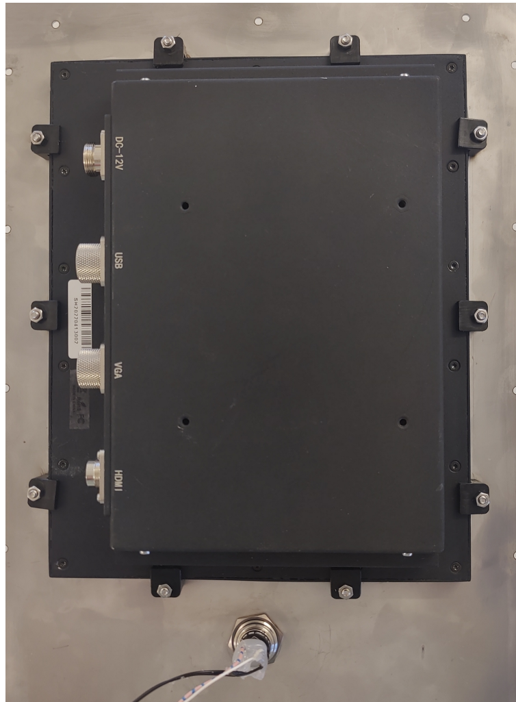
Figur 89: Skjerm festet til frontpanel med 10 plastikk-fester.
