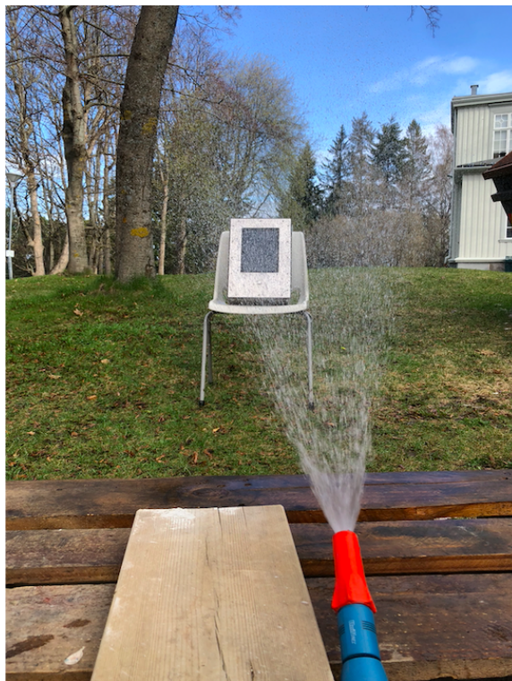
Figur 52: Oppsett til testene som ble utført for de ulike typene tetningslister.
