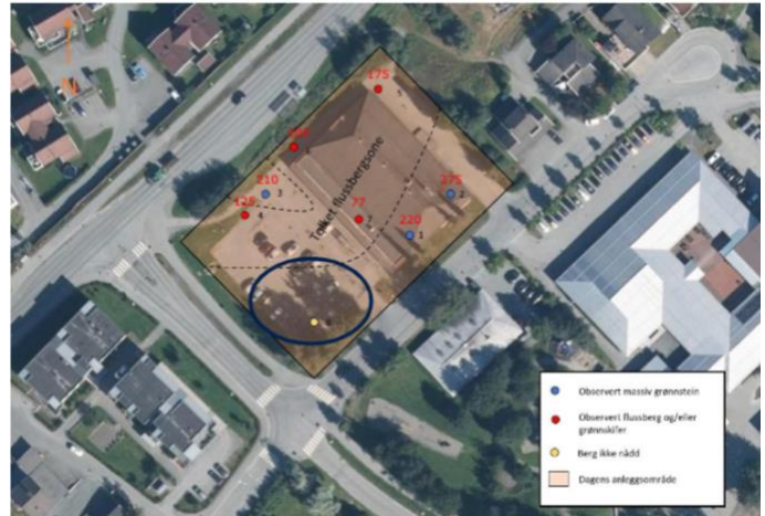
Figur 3 - Oversiktsbilde med observasjoner av berget
