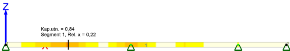
Figur 55: Kapasitetskontroll av bjelke (10) med bruk av HEB-280
