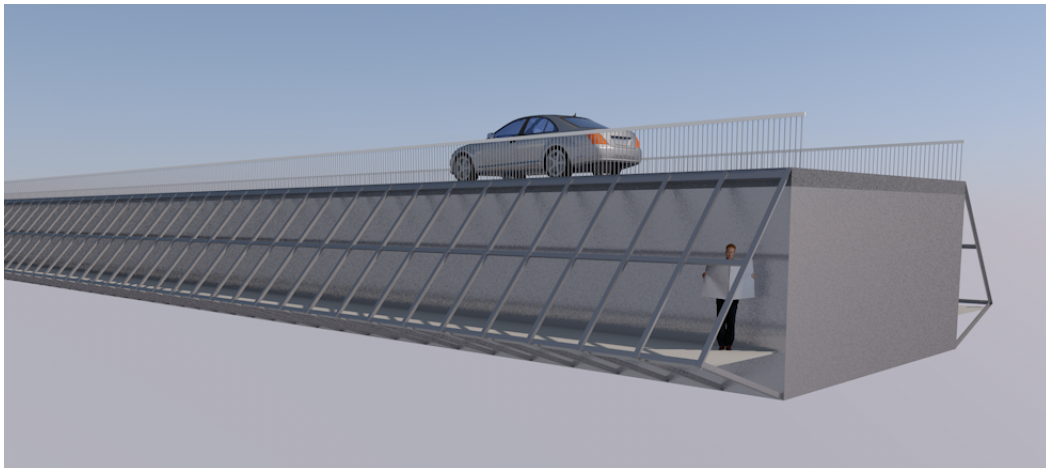
Figur 5.3: Rammeverket montert på broen med gangbro
