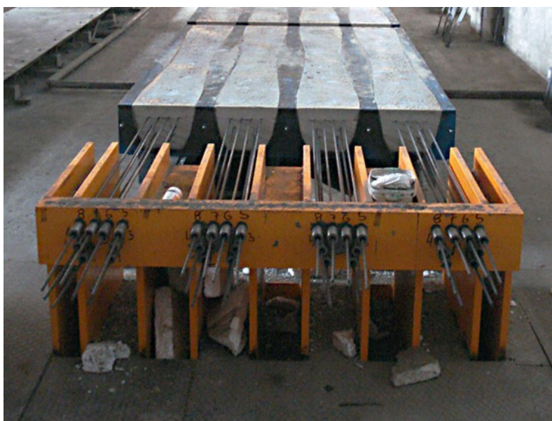
Figur 22: Illustrasjon av et føroppspent betongdekke (Designing Buildings, u.å.).
