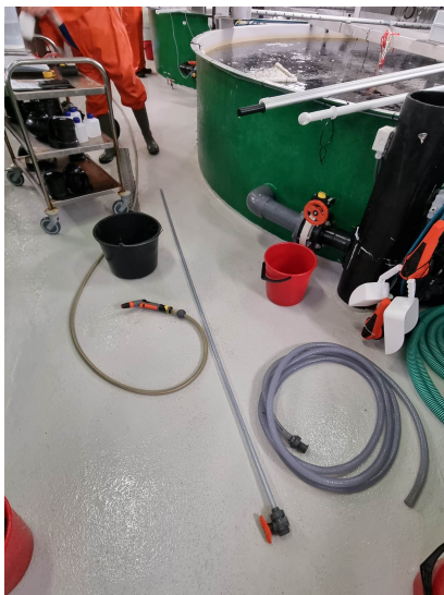
Figur 17: Hevertsystemet som er dekomponert
