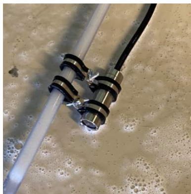
Figur 21: Robust rustfritt kamera som er såpelagt
