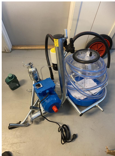
Figur 8: Bygging av det nye røkterutstyret, her er de delene fra den mobile melkemasinen som ble benyttet.
