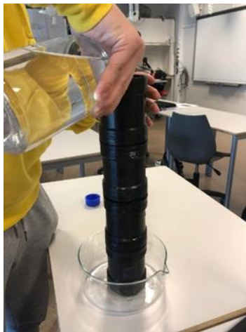
Figur 8: Alle filterstørrelsene bygd sammen i et tårn. Det 500 \mu\text{m} øverst, deretter: 210 \mu\text{m} , 80 \mu\text{m} og 40 \mu\text{m} . Bilde hentet fra elev 10.
