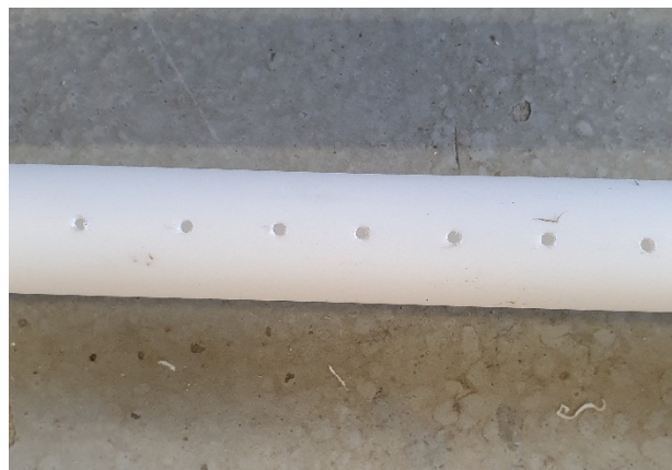
Figur 22: Skimmer med hull på linje klar før testing. Hullene er 3 mm i diameter og er spredt utover en lengde på 60 cm. (Foto: Nicholas F. Ødegård)
