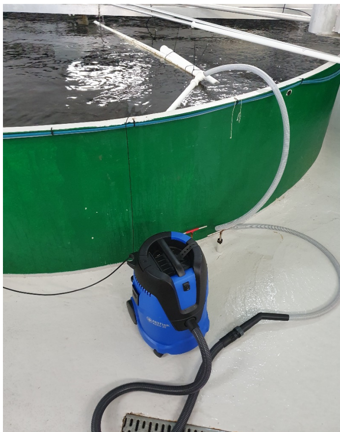
Figur 24: Oppsett under testing. Våtsugeren er koblet til slange som i andre enden er koblet til skimmeren plassert i oppdrettskaret. (Foto: Nicholas F. Ødegård)
