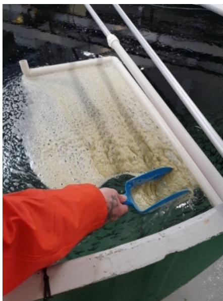
Figur 8: Uttak av organisk materiale fra eksisterende protein skimmer utført med spade (Foto: Nicholas F. Ødegård)
