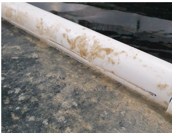
Figur 21: Bildet viser skimmeren etter testing av slisser. Slissene er horisontale med en høyde på 2 mm og kan observeres på skimmeren rett over vannoverflaten. (Foto: Nicholas F. Ødegård)
