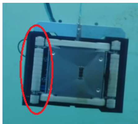
(b) En av to roterende børster er markert på bildet, de er montert foran og bak partikkeloppsamlingen (Mainstay, 2022)
