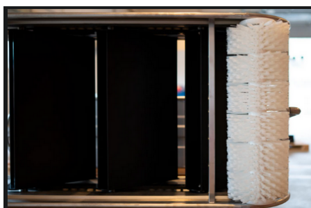
(a) Den hvite roterende børsten på riggen til HALO systemet (AquaRobotics, 2023)
