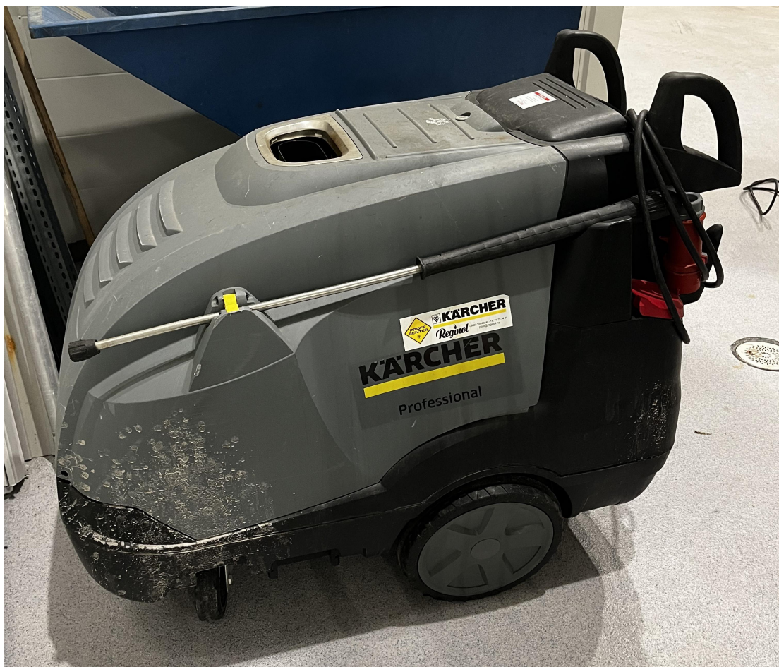
Figur 16: Denne typen høytrykksvasker av merket Kärcher brukes til nedvask ved anlegget i dag. (Foto av Baglo 2023)
