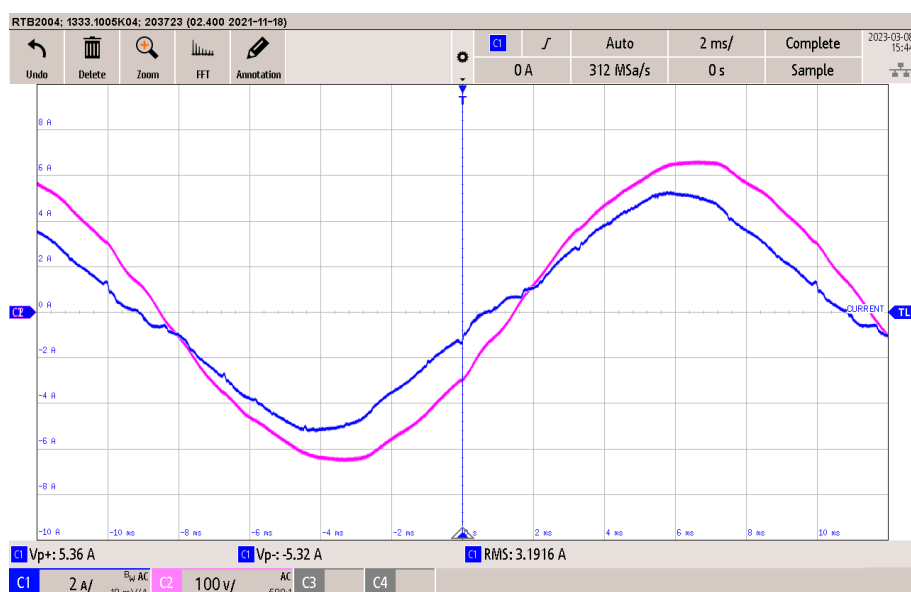
Figur 2.15: Skjerm bilde av en måling av strøm (blå) og spenning (rosa) gjort med oscilloskopet Rohde & Schwarz RTB2004.
