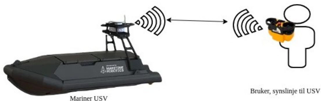
Figur 2: Den originale kommunikasjonsarkitekturen for USV og Hetronic fjernkontroll.
