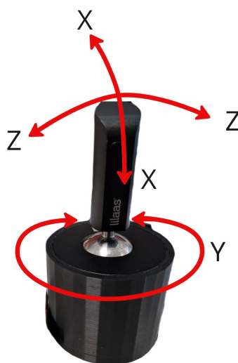
(d) Illustrasjon over hvordan aksene fungerer på joysticken
