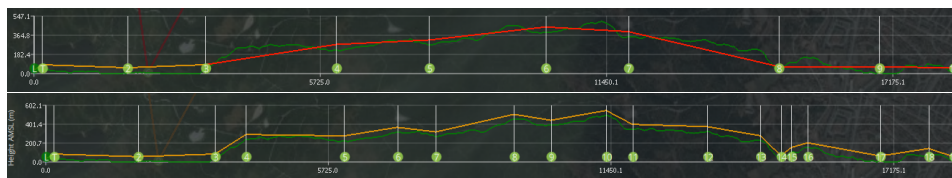
Figur 7.20: Figuren viser resultatet av en stresstest hvor det er mange hindringer. Programmet er ved noen segmenter nødt til å legge til flere punkter underveis for å kunne klare hele ruten.
