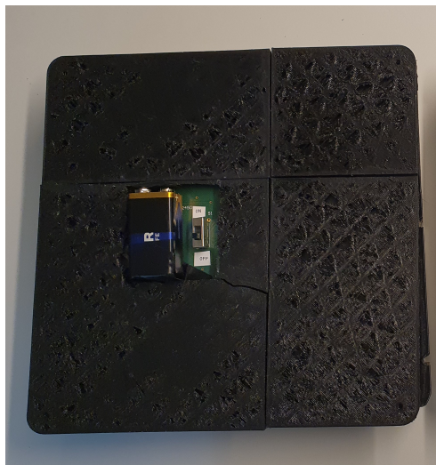
Figur 3.16: Baksiden av 3D-modellene passet PCB-ene
