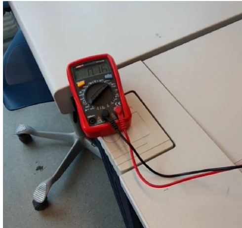
Figur 3.30: Lesing av LDR-spenning med multimeter
