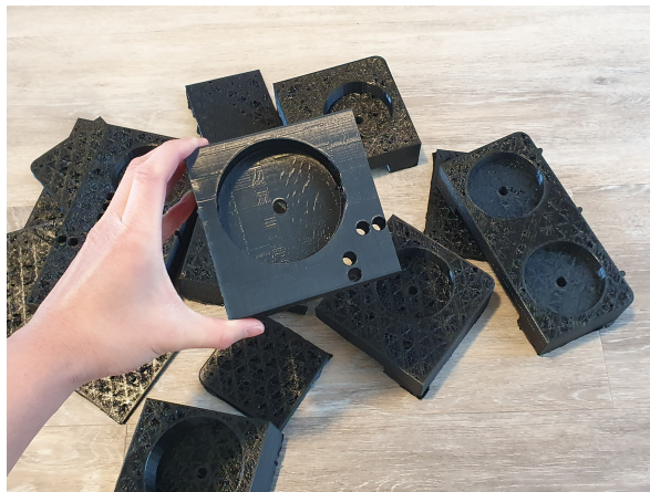
Figur 3.14: Justeringer i 3D-printfilen ga mye bedre 3D-modelldeler
