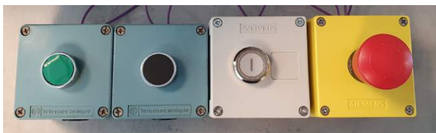
Figur 8: Kontrollpanel med 4 brytere (fra venstre: Start, Stopp, Reset, Nødstop)
