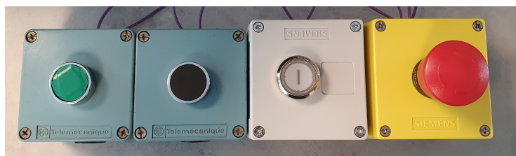
Figur 5.22: Kontrollpanel med 4 brytere (fra venstre: Start, Stopp, Reset, Nød-stopp)
