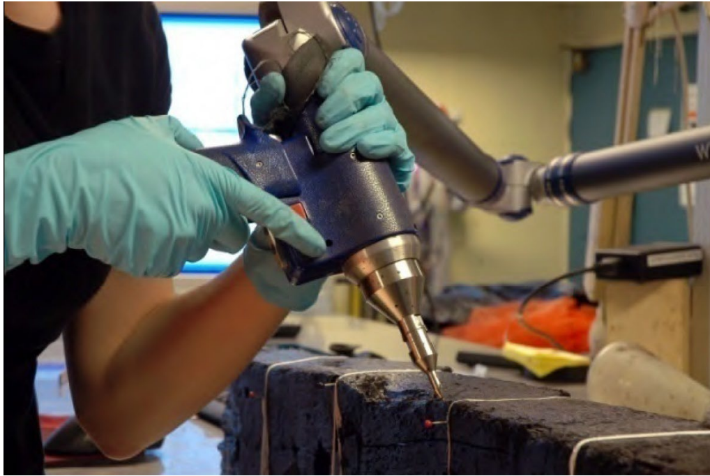
Figur 2. Bilde av en FaroArm i bruk. Måleren settes inntil objektet som digitalt måles, i denne figuren en båtdele, og måles opp gjennom å velge punkter som settes sammen i digitalt tredimensjonalt forhold til hverandre, 2012, Fawsitt, s. 5.
