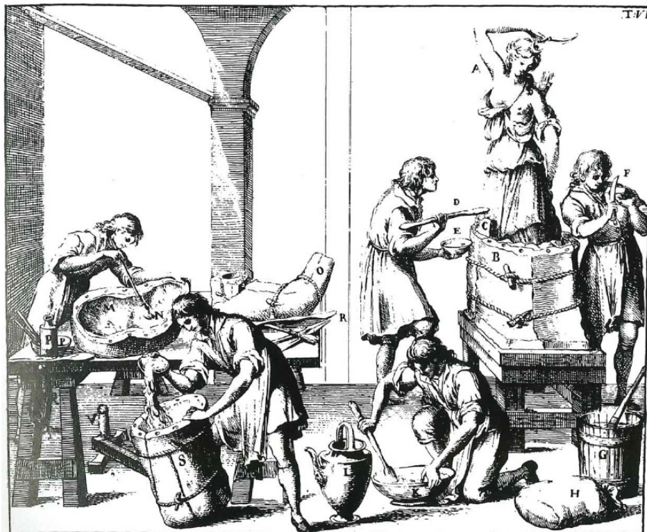
Figur 4. En illustrasjon av en gipsavstøpingsteknikk som er i prosess nær identisk den anvendt av Primaticcio , med unntak av at illustrasjon viser bruken av gips for å fylle formene, istedenfor bronzen Primaticcio brukte. På høyre siden av bildet er påføringen av gips for å skape formen avbildet, midt i bildet foregår miksing av gips og til venstre smøres innsiden av en ferdig form med fett før den fylles med gips, 1802, Carradori, via 1981, Haskell & Penny, s. 3.
