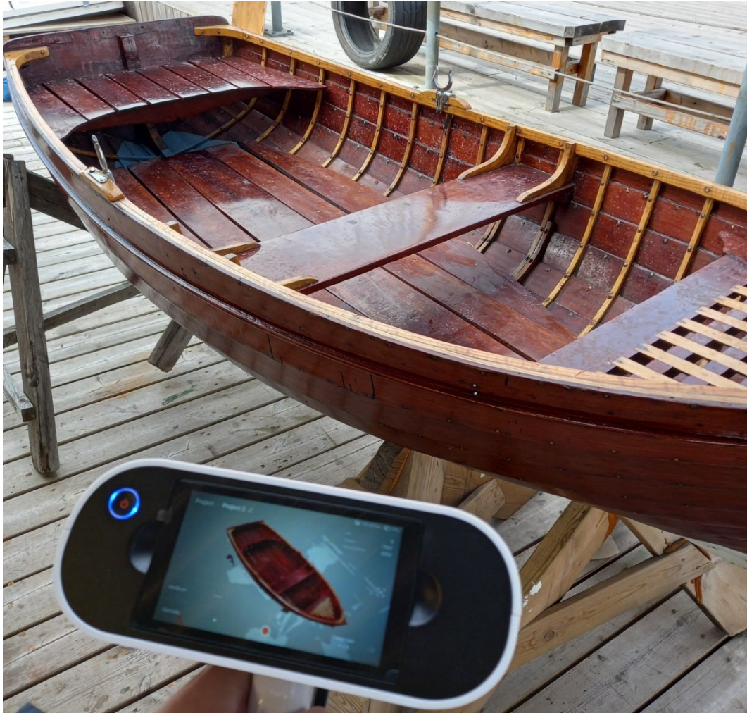
Figur 3. Bilde av en 3D Object Scanner av typen Artec Eva etter å ha skannet oversiden av en Jolle. Den resulterende informasjonen kombinerer de skannede dimensjonene til jollen og bildene av dens visuelle utseende. Dette skannet ble i etterarbeid satt sammen med et annet skann av jollens underside for å skape en hel modell av jollen fra alle vinkler, 2022, Mikael Sommervold.
