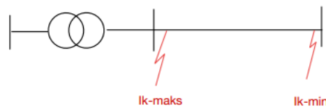
Figur 3.23: Eksempel på kortslutning for I_k maks og I_k min
