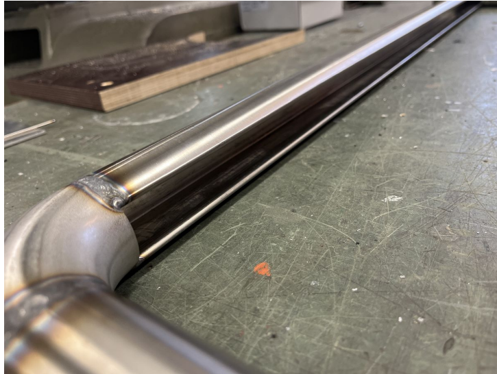
Figur 4.1.2: Nedfelt U-profil i fergeport. Tilpasset PMMA-plate.
