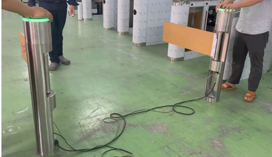
Figur 3.2.1: Landport bestilt fra Kina. Bildet er sendt fra produsent. Grønt lys indikerer at porten er åpen og det er klart for å gå av eller på fergen [8].
