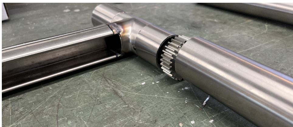
Figur 5.2.1: Tannhjulet som skal sveises inn i rammen på fergeporten.
