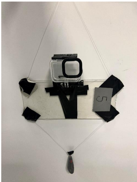
Figur 3. Oppbyggingen av rigg 4 og 5. Pleksiglass utgjorde riggen, hvor kamerahus var påmontert i toppen, og lodd var festet med sener i bunnen.
