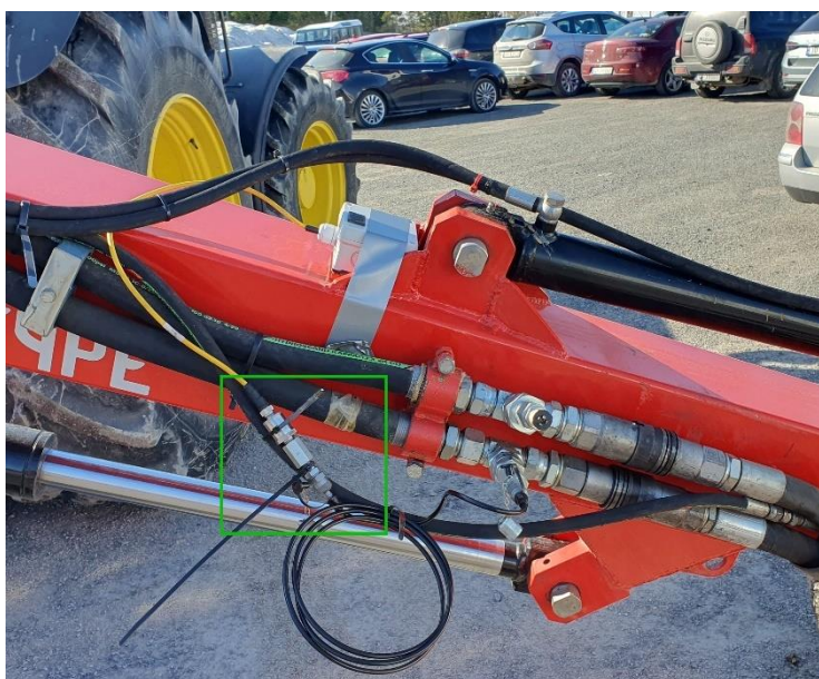
Figur 4.11: Sensornode 2 festet oppå armen med trykksensor stripset fast i slange
