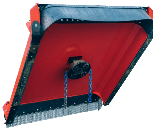
Figur 4.14: Underside av krattknuser med kjede. Bildet er av en annen modell med tilsvarende kjede hentet fra Tokvams produktkatalog 2021[6]
