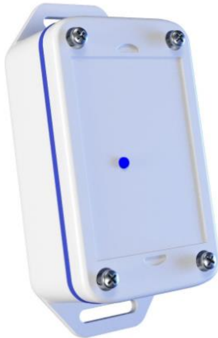
Figur 2: En slutt enhet som består av sensorer som temperatur, fuktighet og falledeteksjon. (7)
